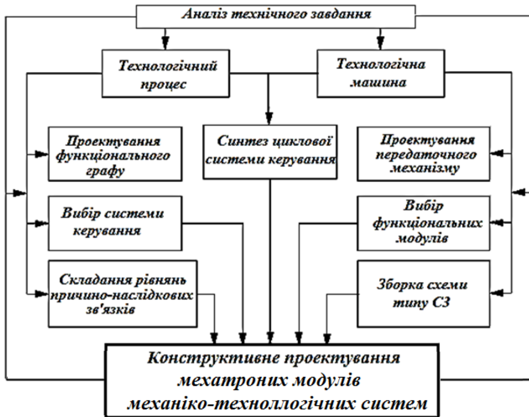
Рис. 3.5. Топологія традиційного конструктивного проектування мехатронних систем технологічних машин
