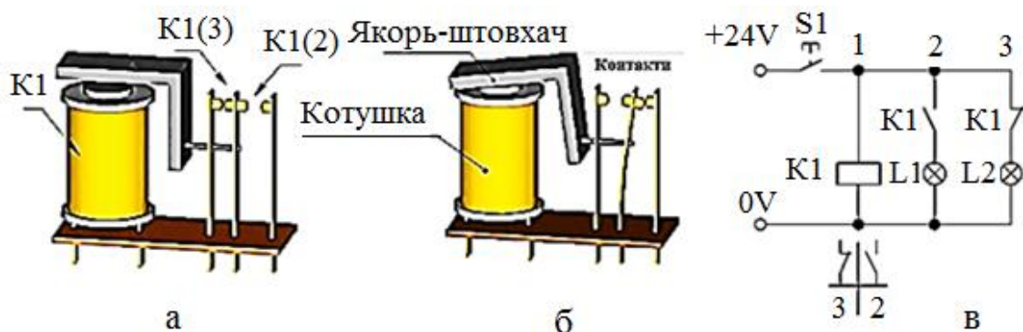
Рис. 1.26. Конструктивні схеми і електрична схема включення електромагнітного реле: а – стан реле, коли кнопка пуск S1 не натиснена, при цьому індикатори L1 та L2 відключені від джерела струми; б – стан реле, коли натиснута кнопка пуск S1, при цьому індикатор L1 включений, індикатор L2 – вимкнений.
