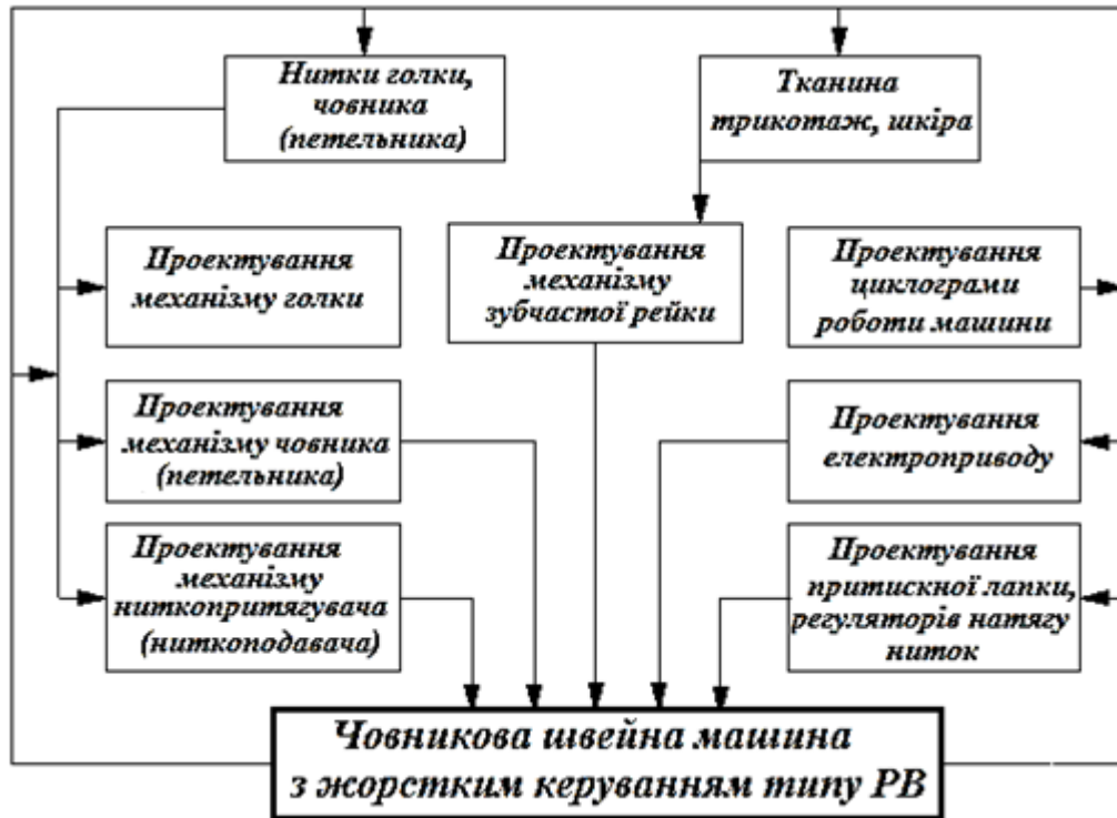
Рис. 3.1. Топологія традиційного конструктивного проектування неавтоматизованих швейних машин
