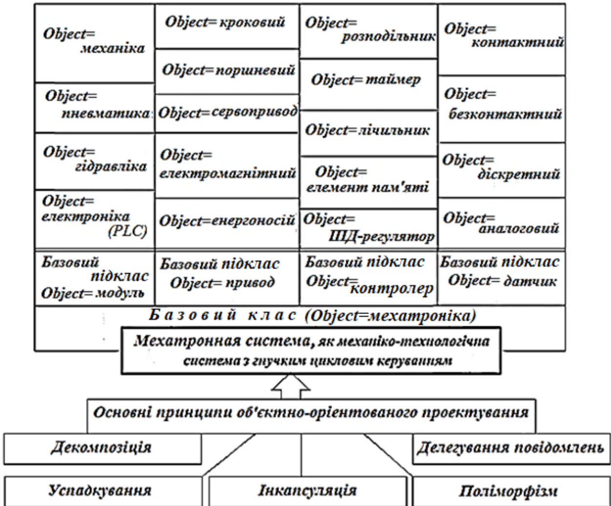
Рис. 3.6. Топологія об'єктно-орієнтованого конструктивно-технологічного проектування мехатронних систем
