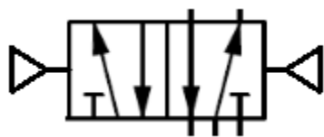
Рис. 1.10. Умовне позначення на схемах типу ПЗ пневмоозподільника п'яти лінійного двопозиційний (тип 5/2) з електромагнітним Бістабільним керуванням
