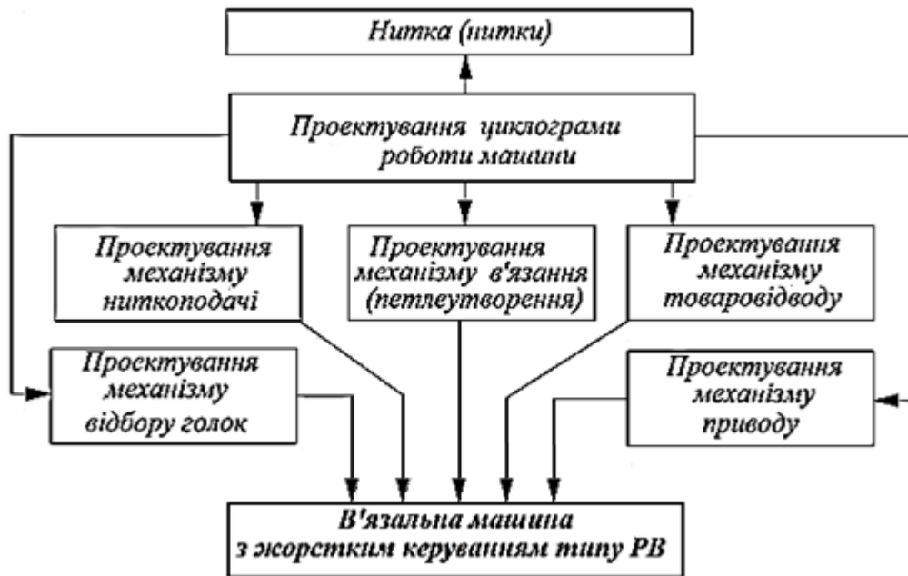
Рис. 3.3. Топологія традиційного конструктивного проектування в'язальних машин
