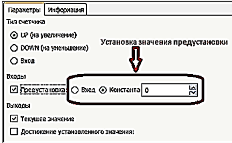
Рис.7.22. Вікно активного стану опції «Попередня установка» параметрів входу лічильника
