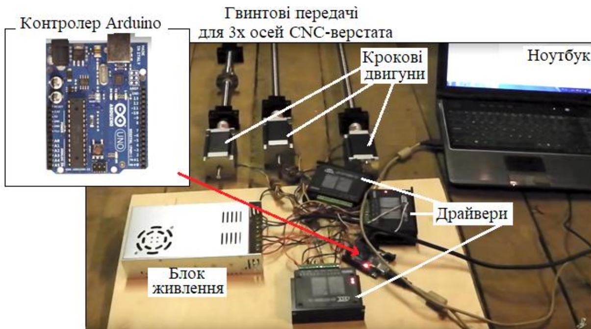
Рис. 1.32. Назва і загальний вигляд типових елементами мехатроніки для побудови мехатронних і роботехнічних систем
