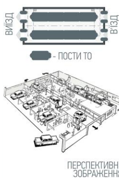
Рис. 2.9 Пропозиції з планування приміщень зони технічного обслуговування автомобілів у багатоповерховій автостоянці
