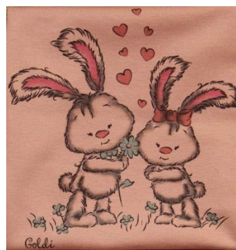
Рис. 2. Зовнішній вигляд дослідних зразків трикотажу з малюнками, одержаними трафаретним способом: a - зразок № 3; б - зразок № 4
