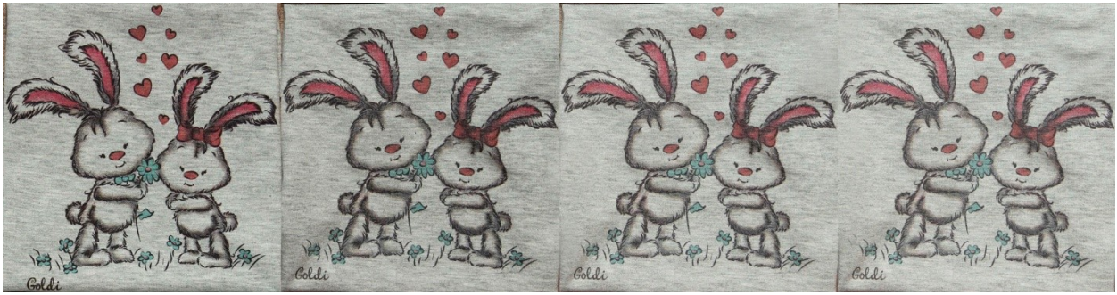
Рис. 4. Характер зміни якості друкованого малюку на меланжевому полотні, нанесеного сублимаційним способом
