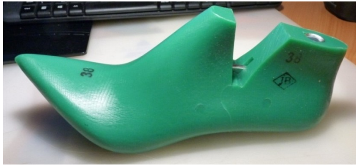
Рис. 12. Колодка, виготовлена на спеціалізованому обладнанні з ЧПК
