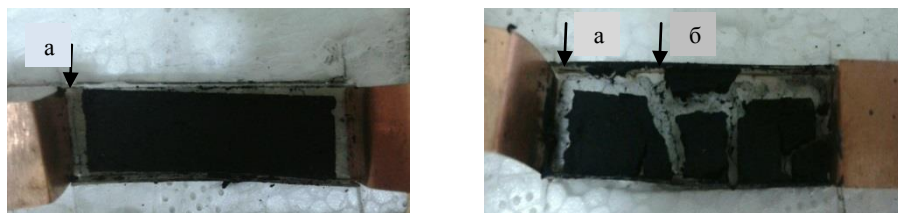
Рис.2. Руйнування електродної маси(а – адгезійне, б – когезійне)
