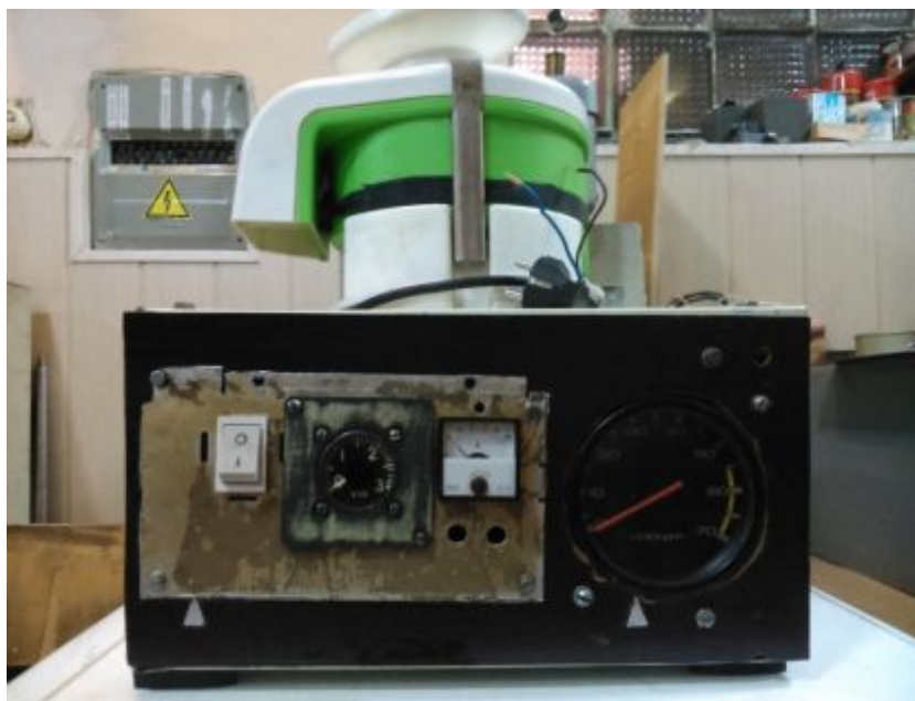
Рис. 3. Лабораторний стенд для дослідження режимів роботи відцентрової соковижималки
