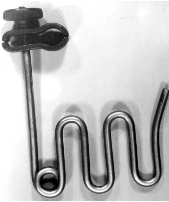
Рис. 2.19. Стоєчний нитконатягувач типу «змійка» та розрахункова схема для визначення натягу ведучої гілки нитки з урахуванням м'якості та жорсткості на вигин.
