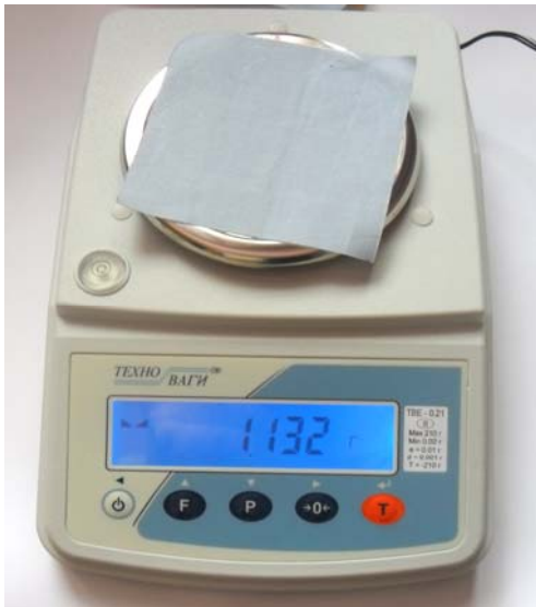
Рис. 8.22. Експериментальне вимірювання поверхневої густини тканини арт. № 1В1928/180:
