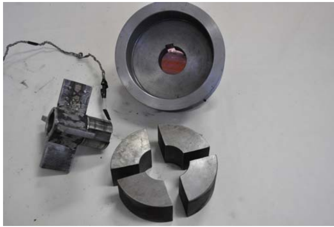
Рис. 7.1.8. Відцентрова фрикційна муфта (розібрана)
