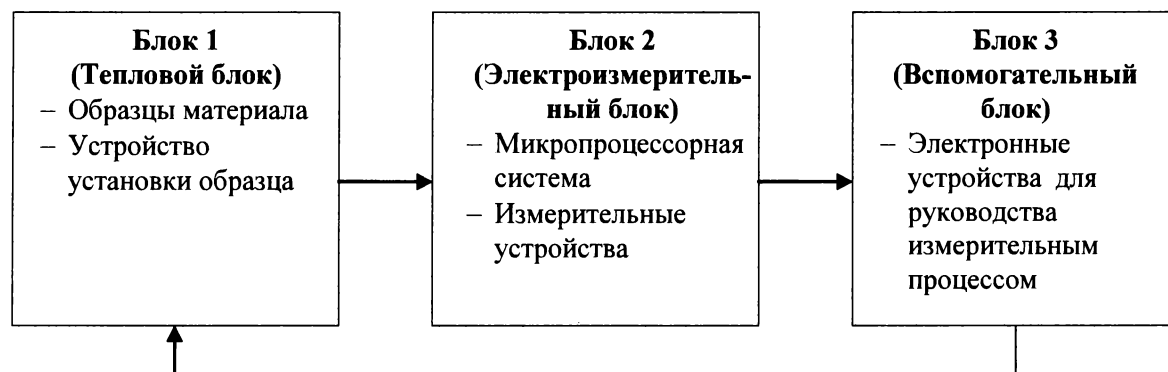
Рис. 2. Структурная схема устройства для измерения теплопроводности текстильных материалов
