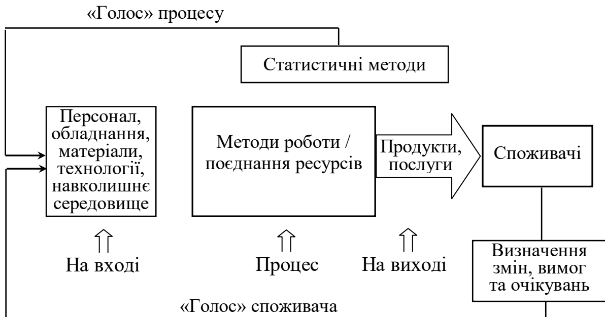
Рис. 1.1. Модель управління процесами із зворотним зв'язком
