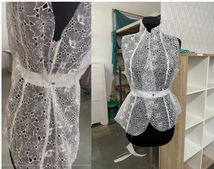
Рис. 3.7. Формоутворення виробу методом наколювання та процес виготовлення.
