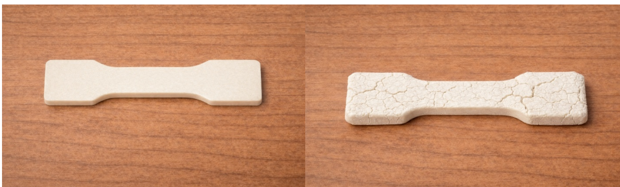
Рисунок 3.5 – фото дослідного зразка LLD6 до та після повного вологопоглинання
