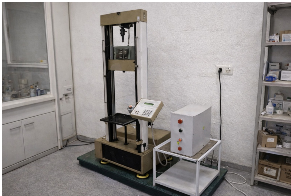
Рисунок 2.4 – розривна машина P-50 2167
