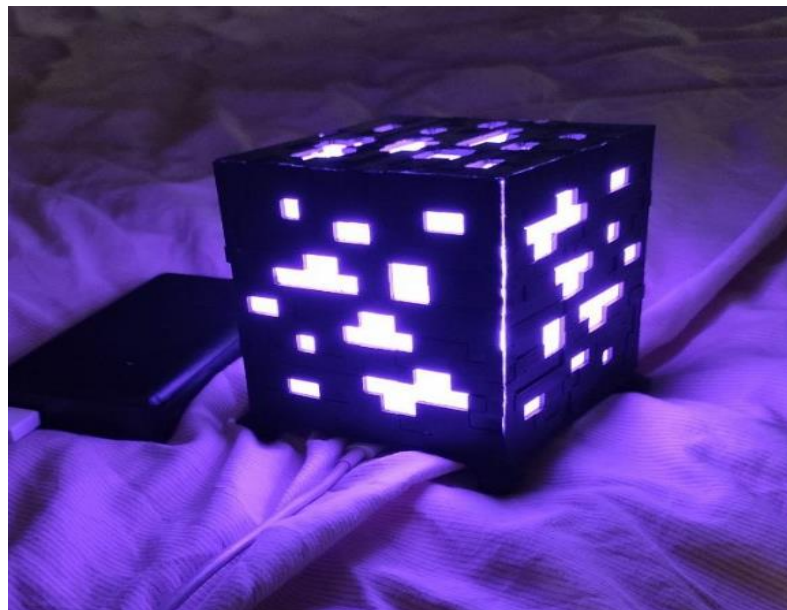
Рисунок 2 – Фізичний прототип пристрою в 3D-друкованому корпусі; живлення від PowerBank
