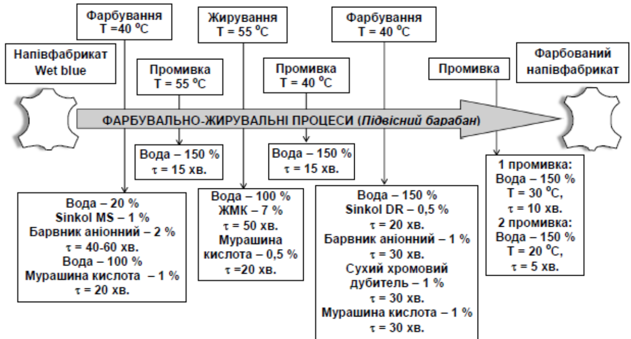
Рисунок 4.20 – Технологічна схема емульсійного жирування напівфабрикату
