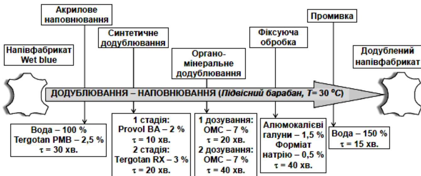
Рис. 4.15 – Технологічна схема додублювання-наповнювання шкіряного напівфабрикату ОМС
