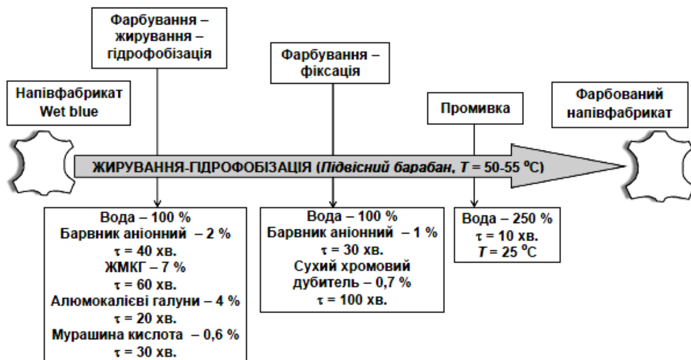
Рисунок 4.23 – Технологічна схема емульсійного жирування-гідрофобізації шкіряного напівфабрикату
