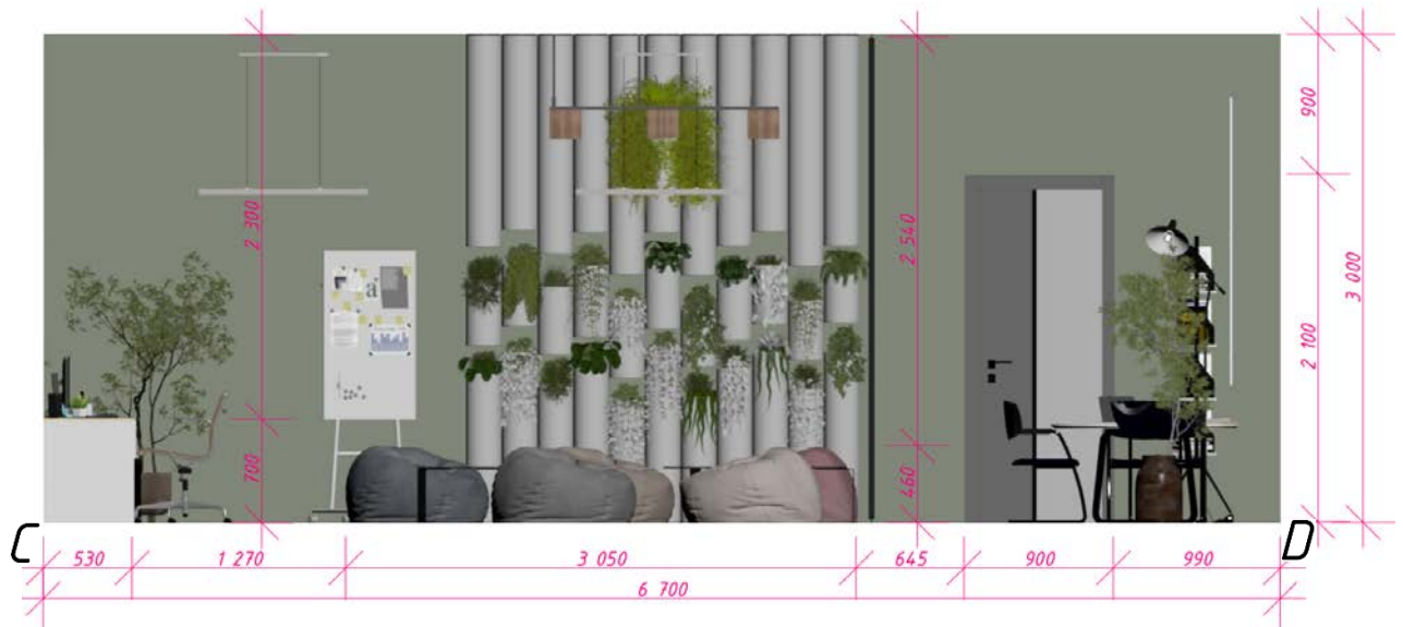
Рис. 3.11. Розгортка стіни основного приміщення С – D
