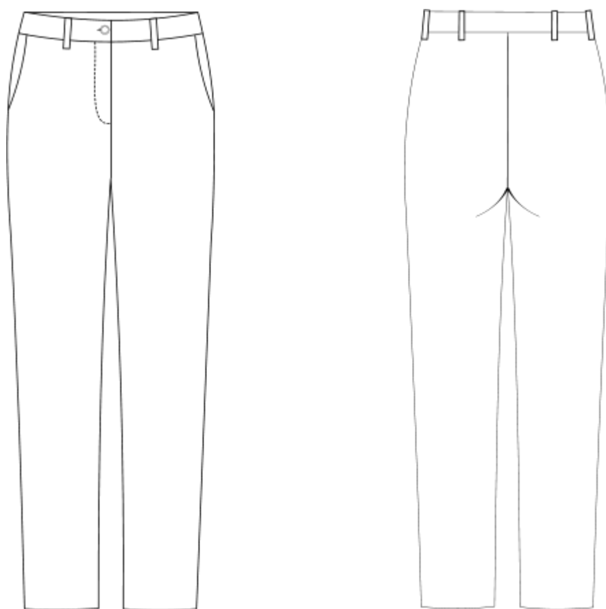
Рис. 4.2 Технічний ескіз брюк
