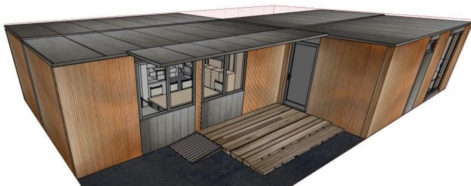
Рис. 3.15. Зовнішній вигляд будівлі. Конфігурація поєднання модульних блоків.
