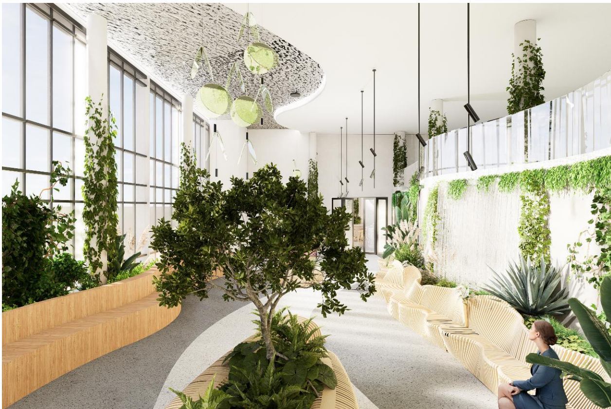
Рис. 3.10 Хвилеподібна стеля з металевими пластинами.
