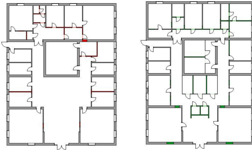
Рис. 3.3. План демонтажу, план монтажу.
