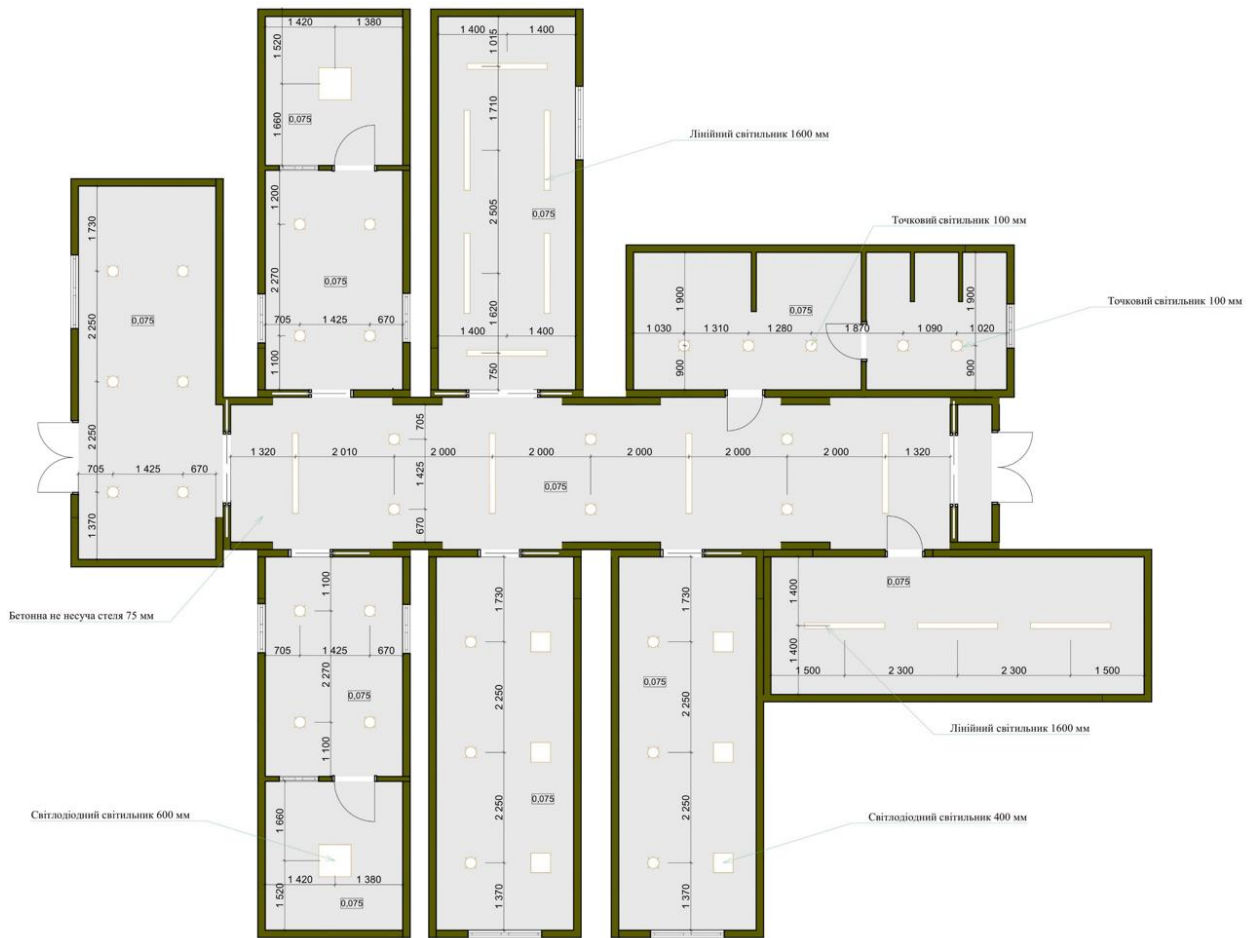
Рис.3.8. План стелі та освітлення
