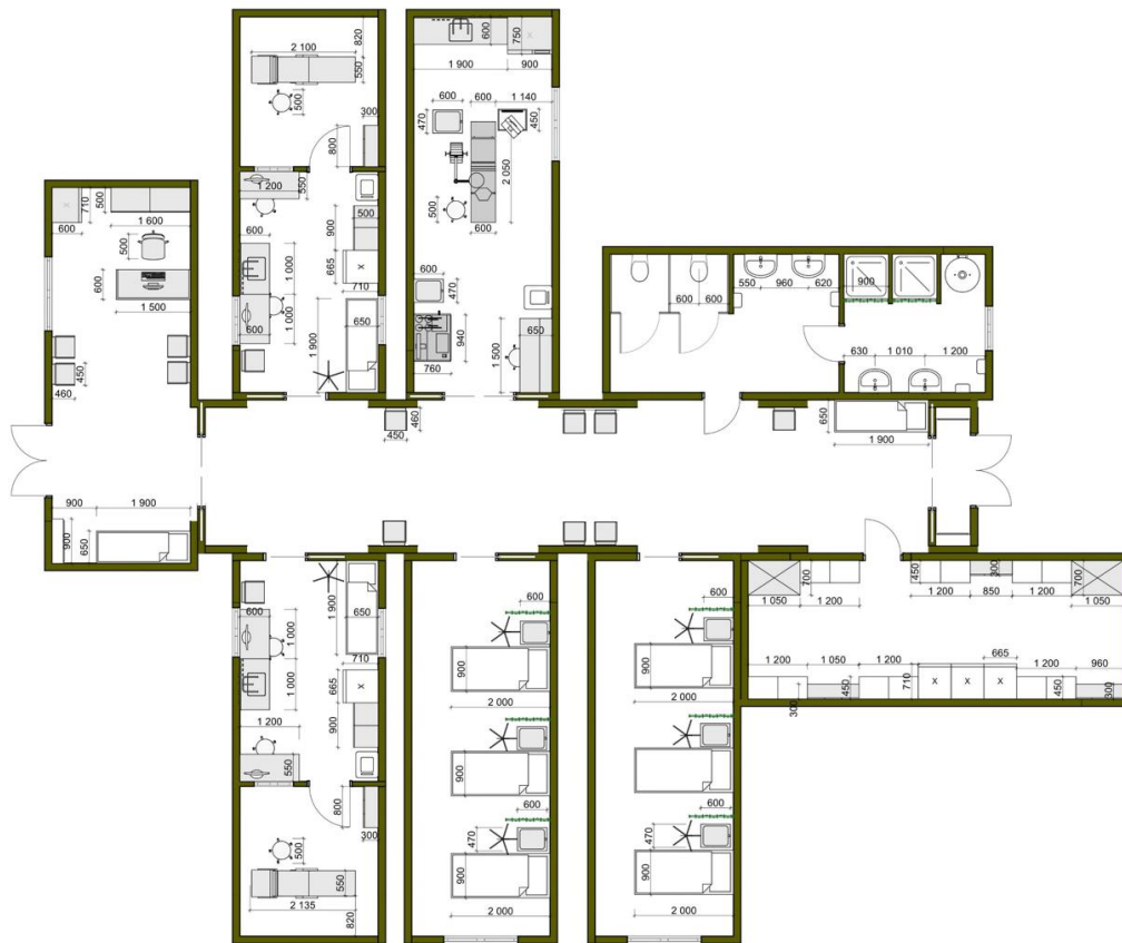
Рис. 3.7. План розташування меблів
