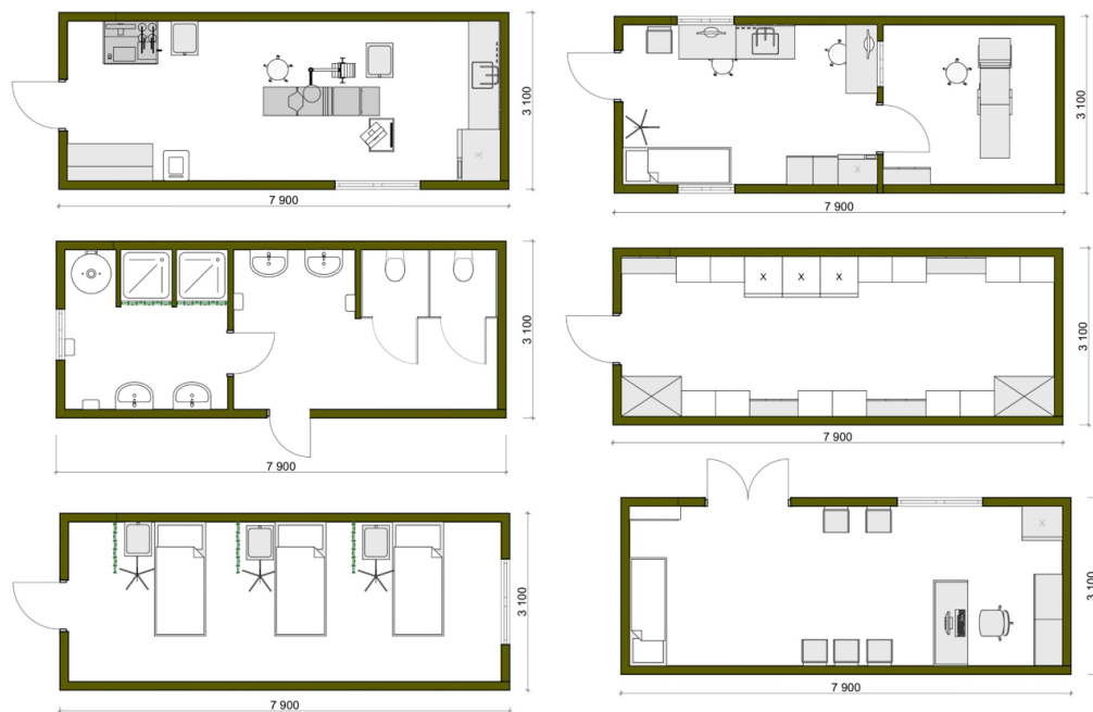
Рис. 3.5. Варіанти планувань модульного блоку під різні потреби
