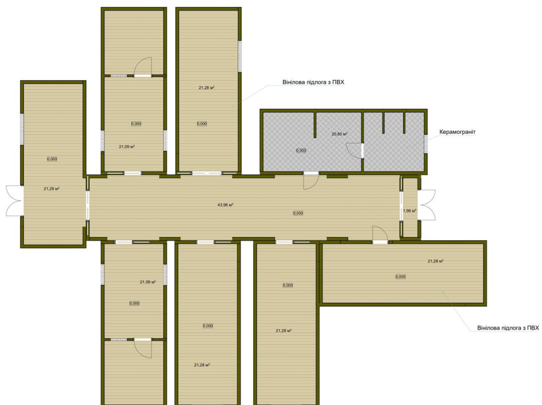
Рис. 3.10. План-схема покриття підлоги
