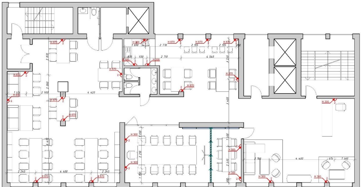
Рис. 3.8. План розеток приміщення
