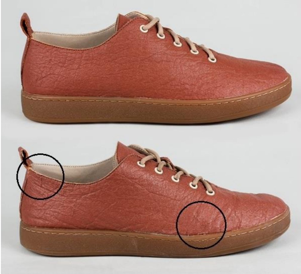
Рис. 3.5 Фото дослідної пари взуття з матеріалу Pinatex до та після 30 днів експлуатації
