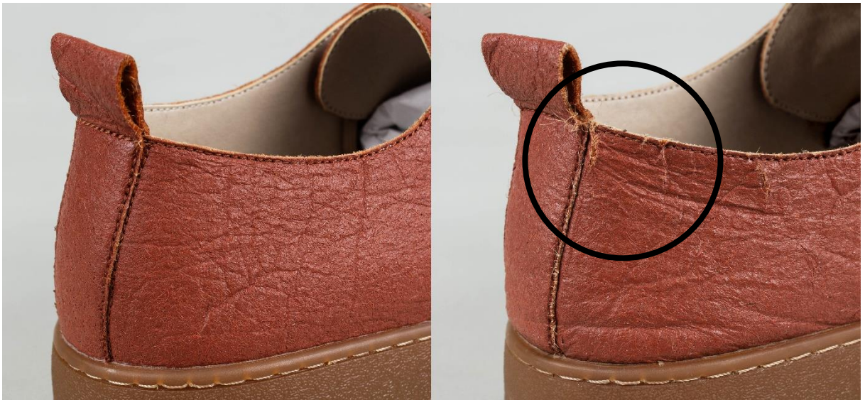
Рис. 3.6 Вигляд верхнього канту в п'ятковій частині дослідної пари взуття з матеріалу Pinatex: а) до та б) після 30 днів експлуатації
