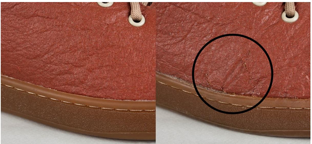
Рис. 3.7 Пучкова частина заготовки дослідної пари взуття з матеріалу Pinatex®: а) до та б) після 30 днів експлуатації
