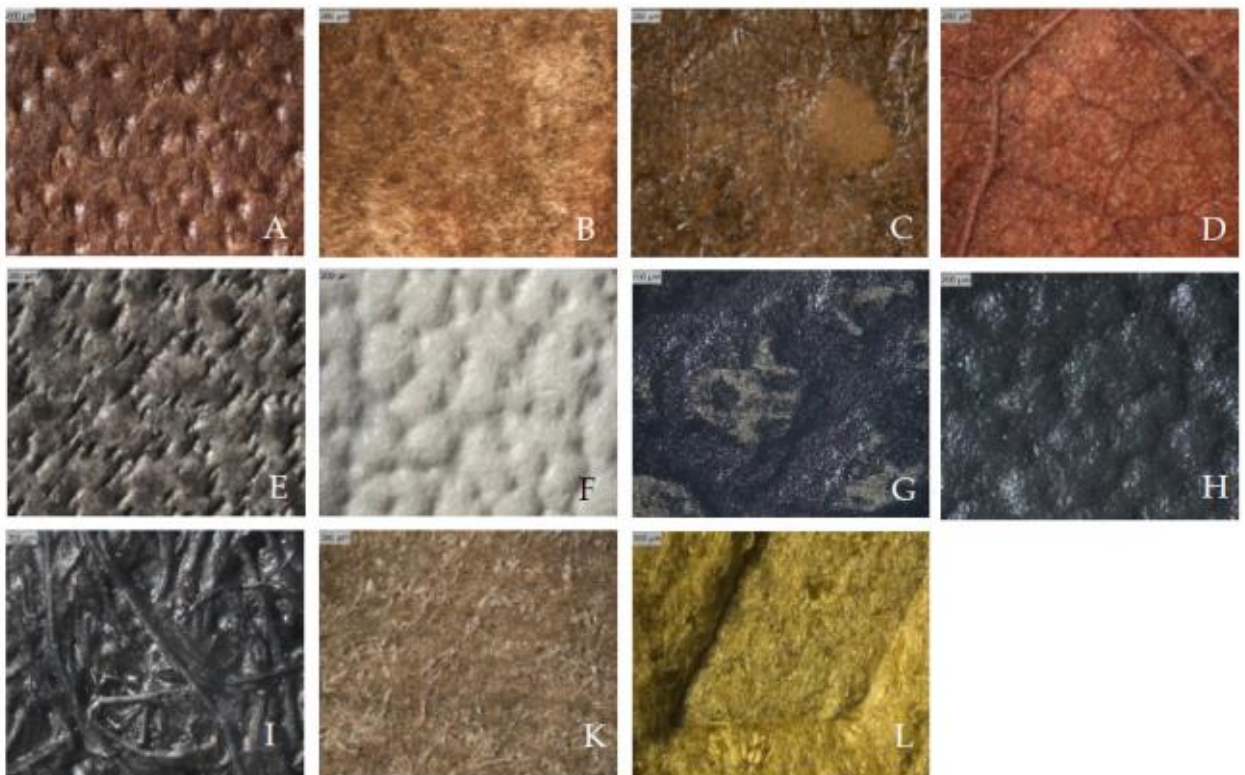
Рис 2.3 Поверхні досліджуваних матеріалів: A) Природний матеріал (шкіра); B), Muskin®; C) чайний гриб; D) Teak Leaf®; E) рельєфні поверхні текстилю з покриттям; F) Desserto®; G) Appleskin®; H) Vegea®; I) волокнисті структури з нетканих натуральних волокон (Pinatex®); K) SnapPap®; L) матеріал з мікрОВОлокна (Noani®)
