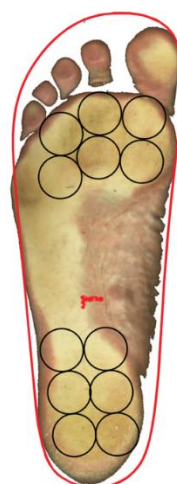
Рис. 3.13 - Схема комбінованого розташування п'єзоелементів
