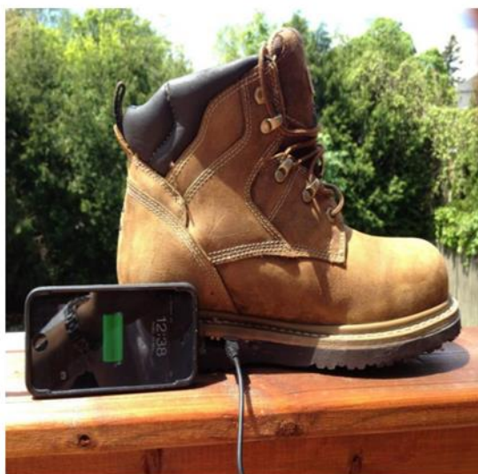
Рис. 1.16 - Взуттєвий пристрій, який перетворює кінетичну енергію в електричну енергію
