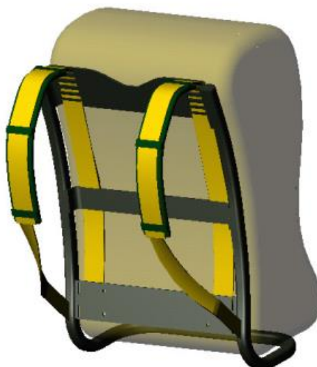
Рис. 1.13 - Схема рюкзака з п'єзоелектричними ремінцями
