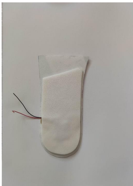
Рис. 4.8 – Розміщення тонкого шару пінополіуретану (ППУ)
