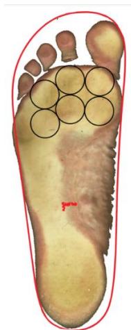
Рис. 3.11 - Схема розташування п'єзоелементів на передній частині стопи
