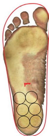
Рис. 3.10 – Схема розташування п'єзоелементів на п'ятовій частини стопи
