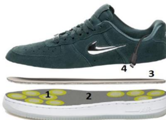
Рис. 1.22 - Модель взуття з п'єзоелектричним матеріалом: 1 - п'єзоелектричні матеріали, 2 – підошва взуття, 3 – вкладна устілка, 4 – USB-кабель
