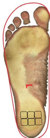
Рис. 3.14 - Схема розташування п'єзоелектронних генераторів зі зрізаним ділянками електрода на устілці з урахуванням найбільшої концентрації тиску в п'ятковій зоні стопи
