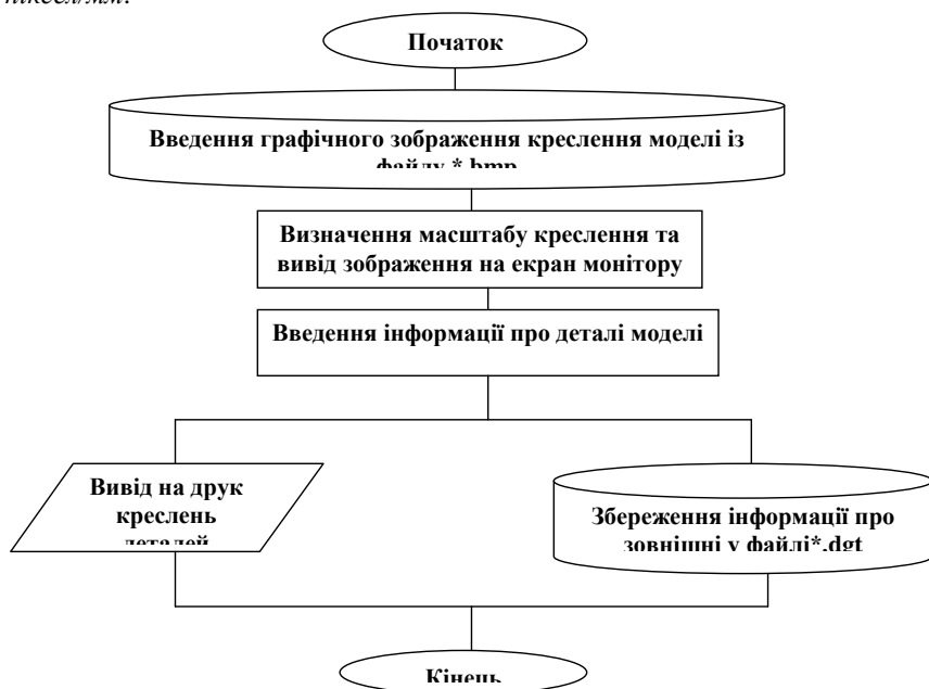
Рис. 8.3.2. Структурна схема алгоритму інтерактивної підготовки інформації про зовнішні контури деталей взуття
