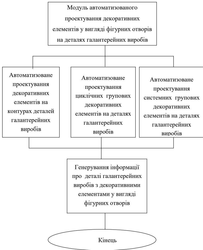
Рис. 8.5.4. Структурна схема модулю автоматизованого проектування декоративних елементів у вигляді фігурних елементів на деталях галантерейних виробів
