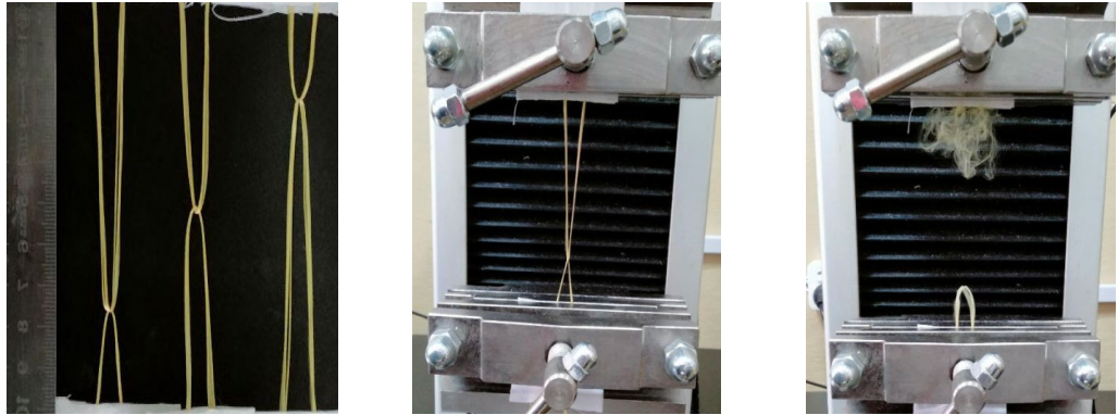
Рис. 4.7 Схема заправки нитки петлею у затискачах розривної машини
