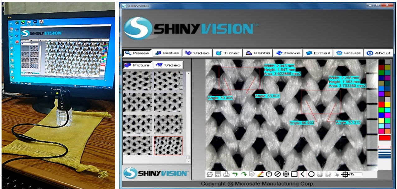
Рис.3.17 Цифровий мікроскоп USB Digital microscope MM-2288-5X-BH та спеціалізоване програмне забезпечення SHINY VISION
