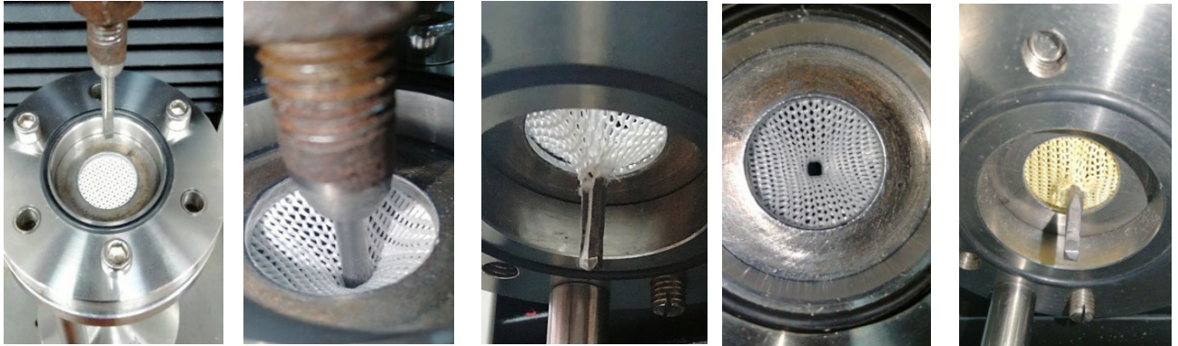
Рис.4.30 Фото моменту проколу стержнем трикотаажних матеріалів, на РА
