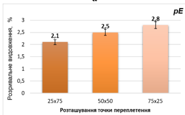
Рис. 4.8 Діаграми при заправці ниток петлею розривального навантаження: а) з UHMWPE нитки; б) з pA нитки розривального видовження: в) з UHMWPE нитки; г) з pA нитки
