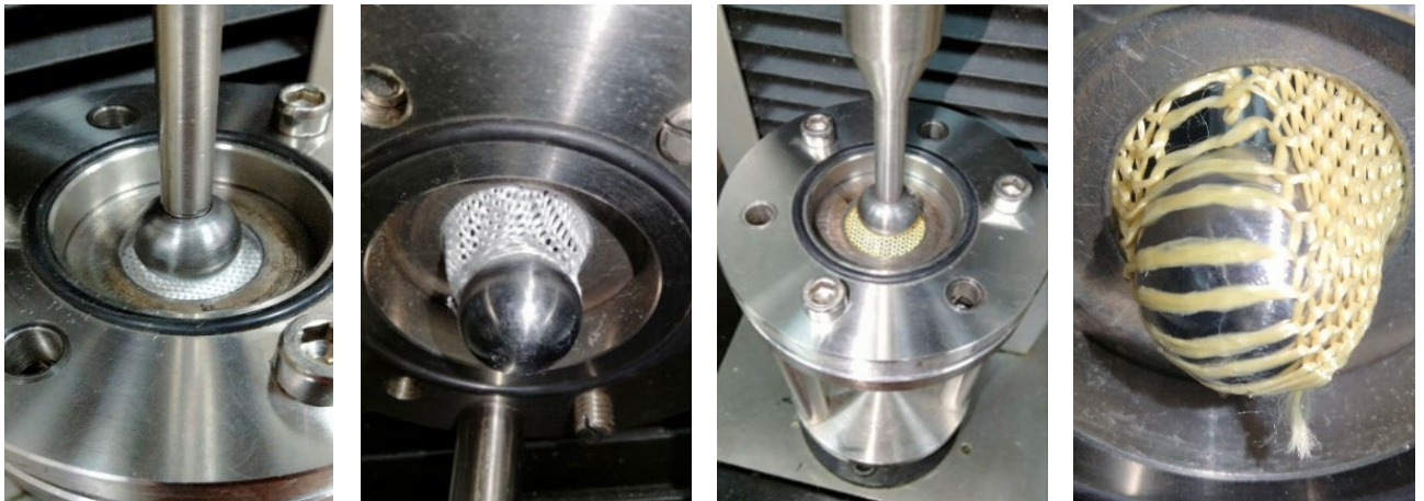
Рис.4.26 Фото моменту продавлювання кулькою трикотажних матеріалів, вироблених на РА
