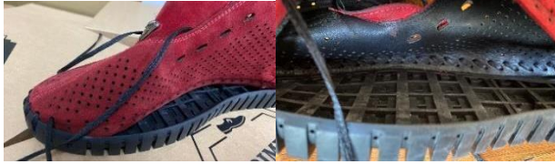
Рис. 3. Приєднання зартовки верху до підшви нитковим швом
