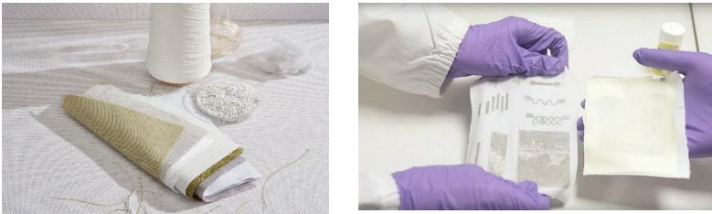
Рис.1. а) Текстильні матеріали під назвою Clean Impact Textiles б) Електрод (зліва), що розтягується, надрукований на трафареті з еластичних чорнил, що містять гумоподібний матеріал, і інтегрований у прототип збору енергії на тканинній основі (справа). NTU Сінгапур©
