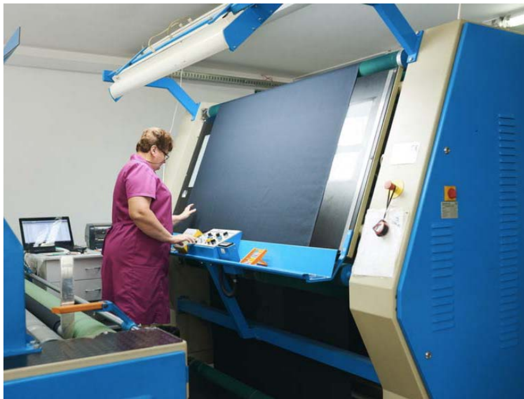
Рис. 3.17. Процес проміру та розбракування матеріалу на станках: а – на фабриці у Турречині; б – на ПРАТ «Едельвіка», м. Луцьк ( https:// edelvika.com/istoriya-rozvitku-kompanii/ )
