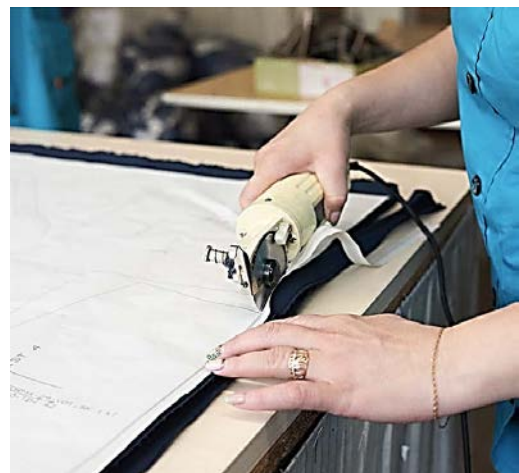
Рис. 4.22. Розкроювання деталей пересувною розкрійною машиною з дисковим ножем
