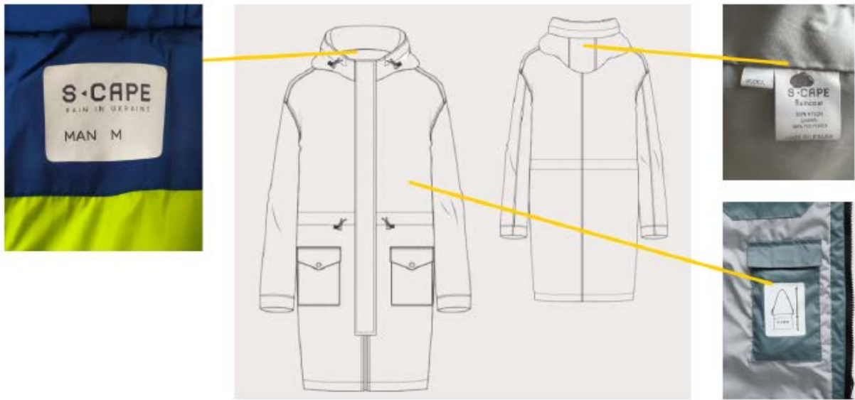
Рис. П.3. Схема кріплення ярликів у куртці-дощовику
