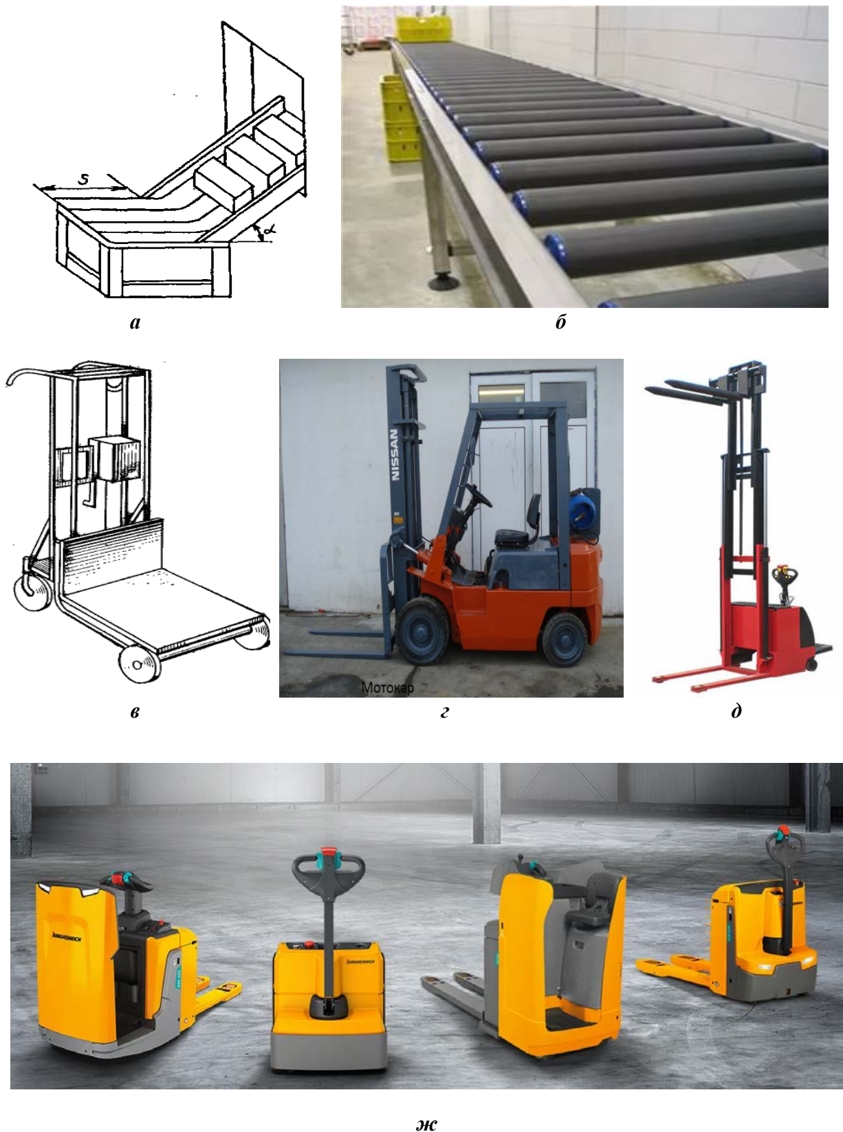
Рис. 3.4. Скат (а), роликовий конвеєр (б), візок з підйомною платформою (в), електроштабелери (г, д) для подачі ролонів та кіп у підготовчий цех, електроштабелери різних конструкцій (ж)
