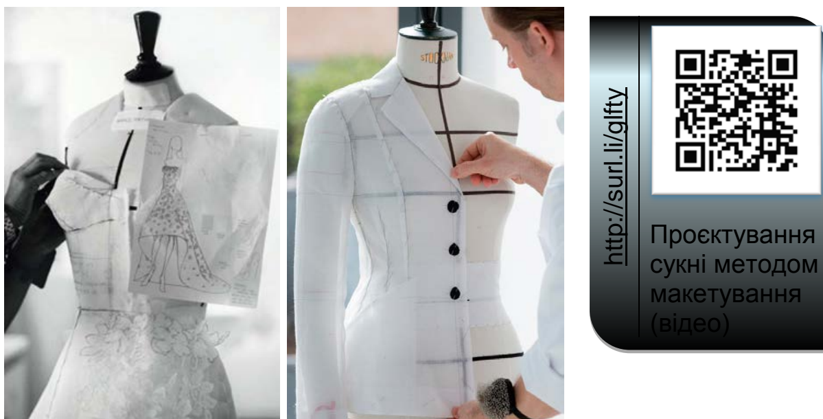
Рис. 2.9. Проєктування виробу методом макетування
