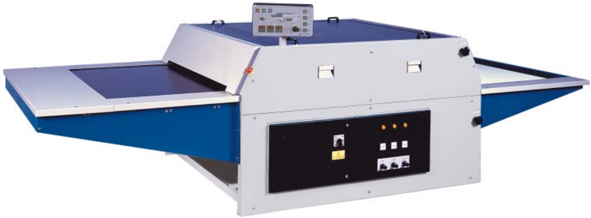
Рис. 4.58. Прес для дублювання прохідного типу (ROTONDI group)
