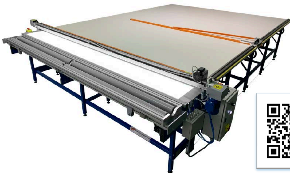
Рис. 4.10. Стіл з напівавтоматичною відрізною лінійкою для розкрою рулонних штор REXEL UK-2 ( https://www.youtube.com/watch?v=6jLqakvI4JE )
