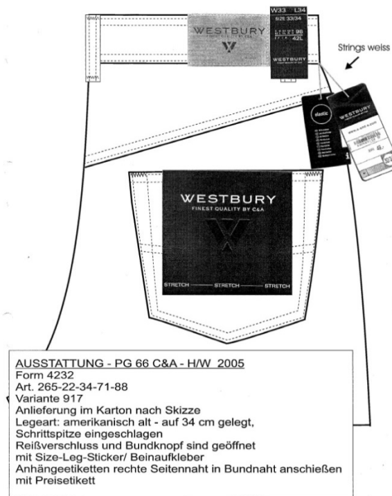
Рис. М.4.1. Схема кріплення навесних ярликів до джинсів, ТОВ «ПолСтар» (м. Кривий Ріг)
