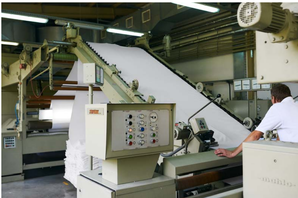
Рис. 3.18. Процес проміру матеріалу: а – на промірочному столі на ТДВ «Трембіта», м. Чернівці; б – на промірочній машині на ПрАТ «Едельвіка», м. Луцьк
