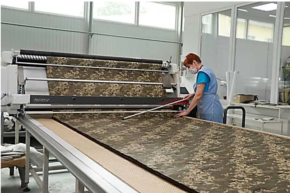
Рис. 4.15. ННК: а – напівавтоматичний настільний комплекс торгової марки Jindex; б – процес настилення на ННК на Прилуцькій швейній фабриці
