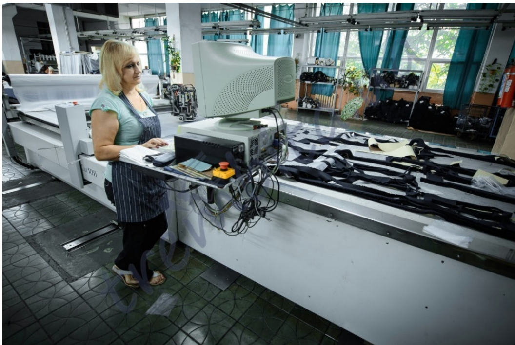
Рис. 4.42. Керування процесом розкрою за допомогою персонального комп'ютера
