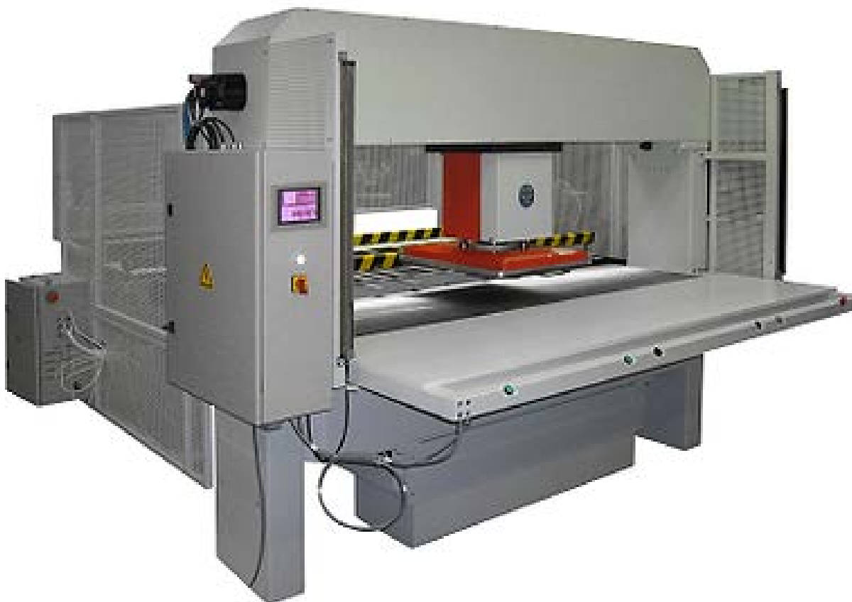
Рис. 4.39. Напівавтоматичний електрогідравлічний прес для вирубання деталей ( https://www.unimark.hu/cutting-machines.html )
