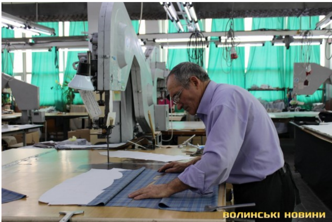
Рис. 4.23. Стационарна стрічкова розкрійна машина: а – зовнішній вигляд; б – робота на стрічковій розкрійній машині в умовах ТДВ «Трембіта», м. Чернівці http://www.trembita.ua/vyrobnytstvo/
