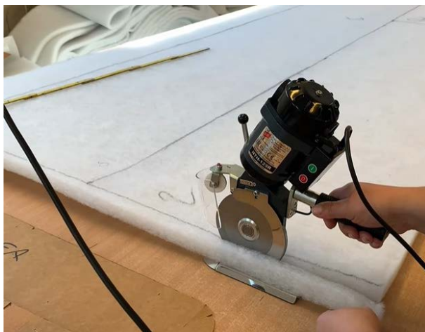
Рис. 4.22. Розкроювання деталей пересувною розкрійною машиною з дисковим ножем
