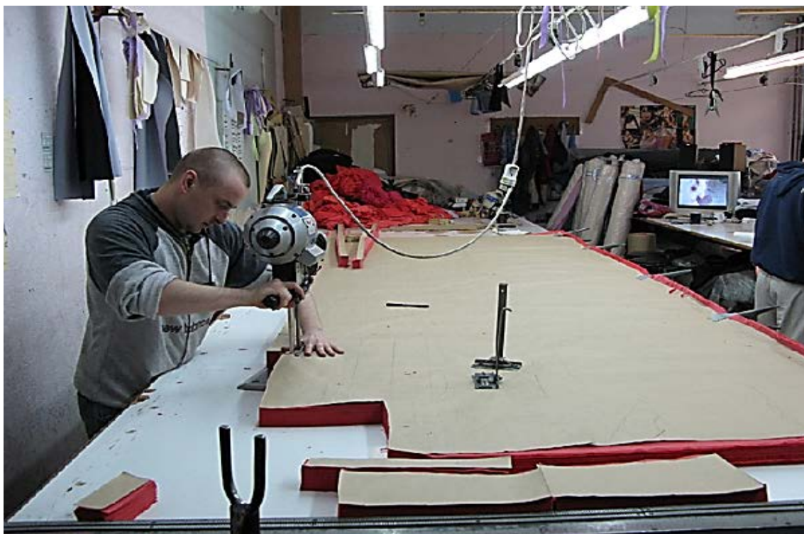
Рис. 4.35. Процес розкрою настилу розкрійною машиною з прямим ножем
