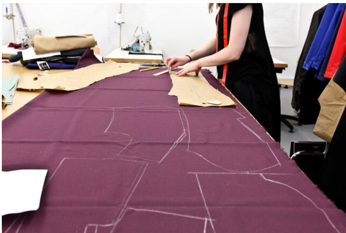
Рис. 2.39. Виконання експериментальної розкладки лекал у ручному режимі: а – рзкладання лекал; б – обкрейдування експериментальної розкладки лекал
