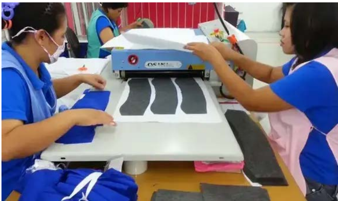
Рис. 4.63 Процес дублювання матеріалів на пресі прохідного типу ( http://surl.li/gpbm )
