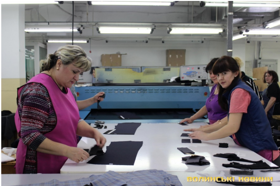
Рис. 4.62. Прийоми роботи на пресі прохідного типу (швейна фабрика «Трембіта», м. Чернівці)
