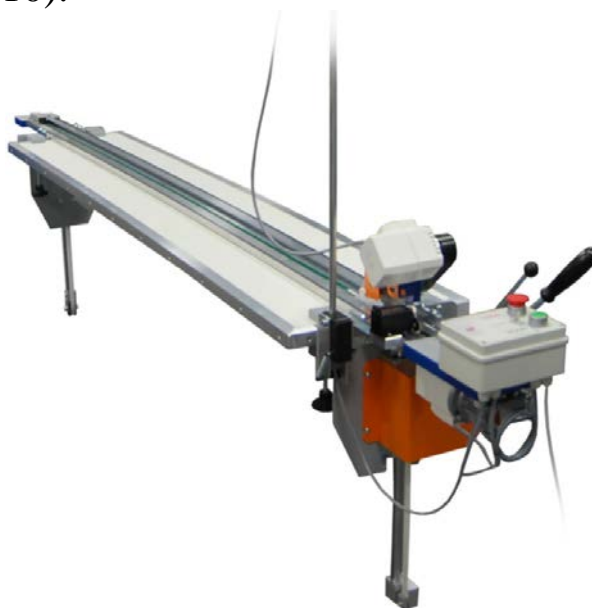
Рис. 4.9. Напівавтоматична відрізна лінійка REXEL OT-1A з лічильником полотен та довжини
