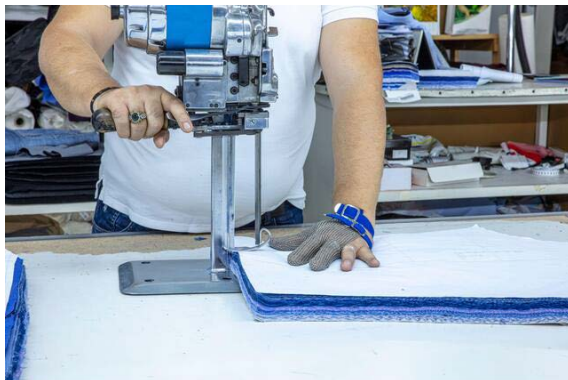
Рис. 4.21. Розкроювання деталей пересувною розкрійною машиною з прямим ножем
