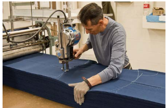
Рис. 4.21. Розкроювання деталей пересувною розкрійною машиною з прямим ножем
