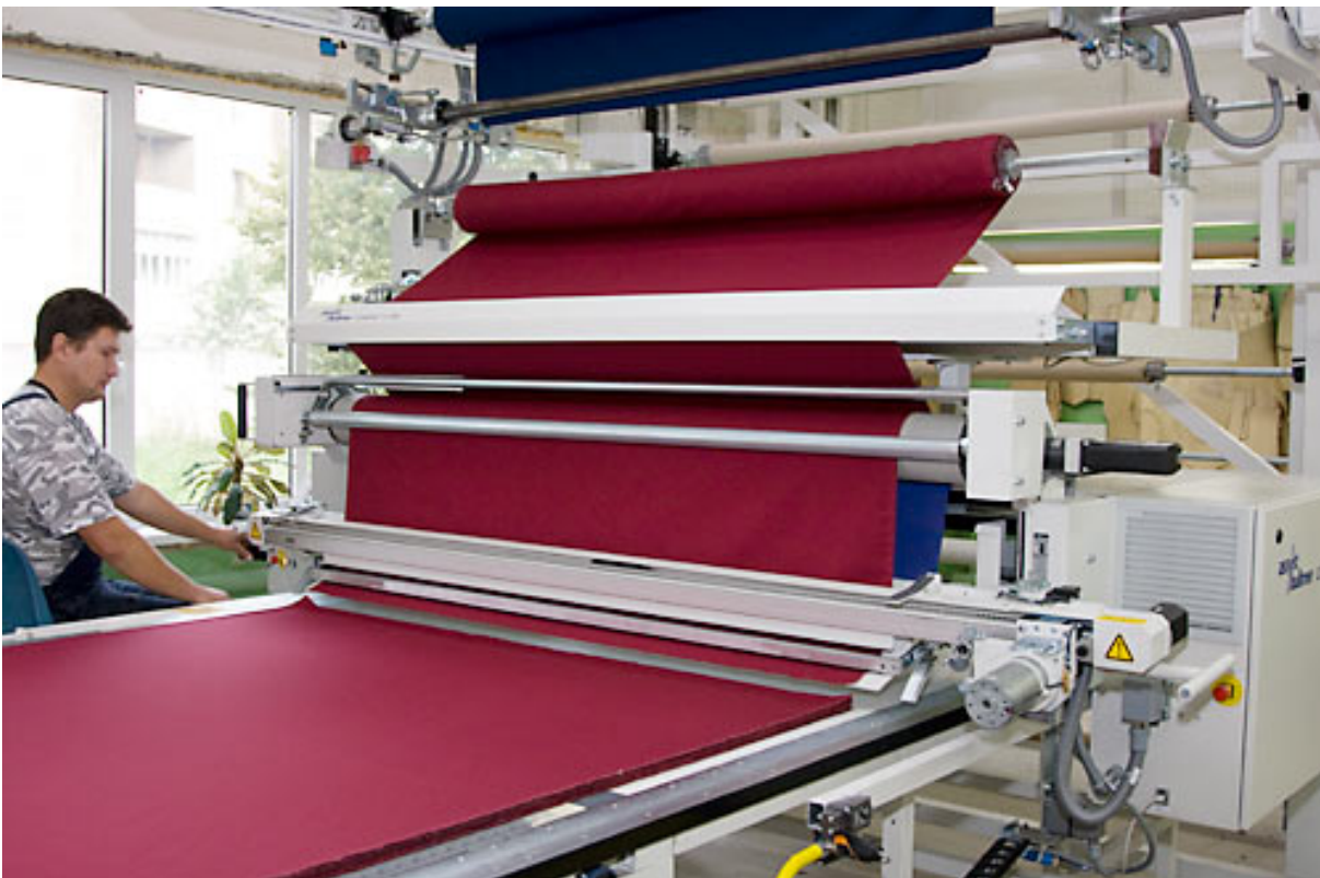
Рис. 4.16. АНК: a – комплекс Kuris Shuttle A55 для напівавтоматичного та автоматичного настилання матеріалів; б – процес настилання
