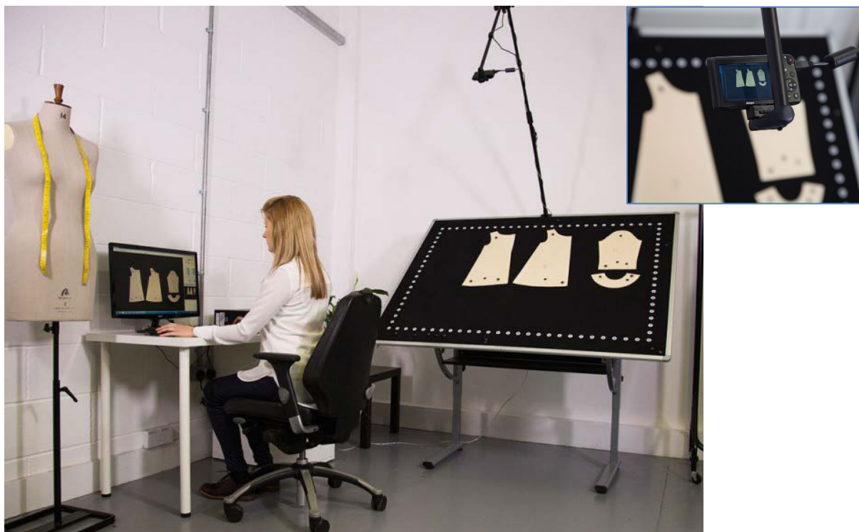
Рис. 2.21. Відцифровування лекал із застосуванням цифрової камери
