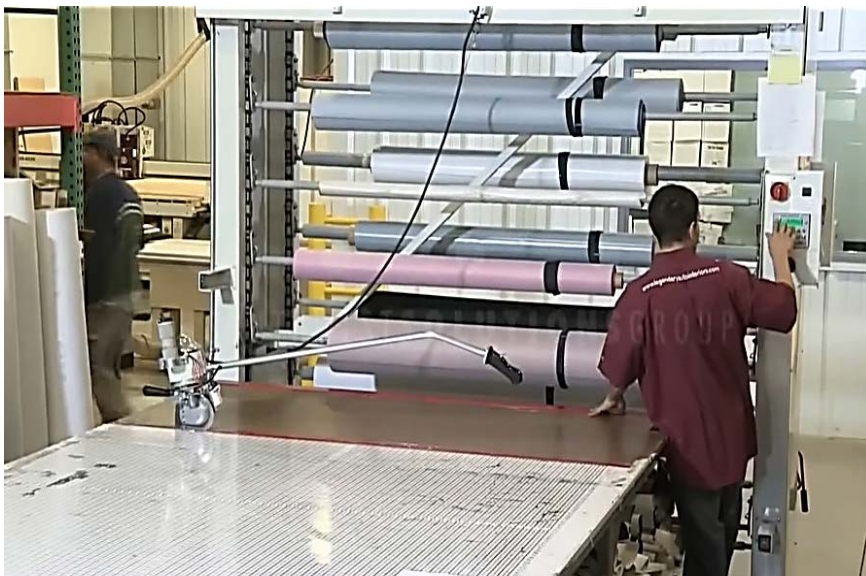
Рис. 4.3. Пристрої для розміщення рулонів матеріалів біля настільних столів: a – механізовані стелажі; б – стійки для розміщення рулонів; в, г – механізовані стелажі елеваторного типу
