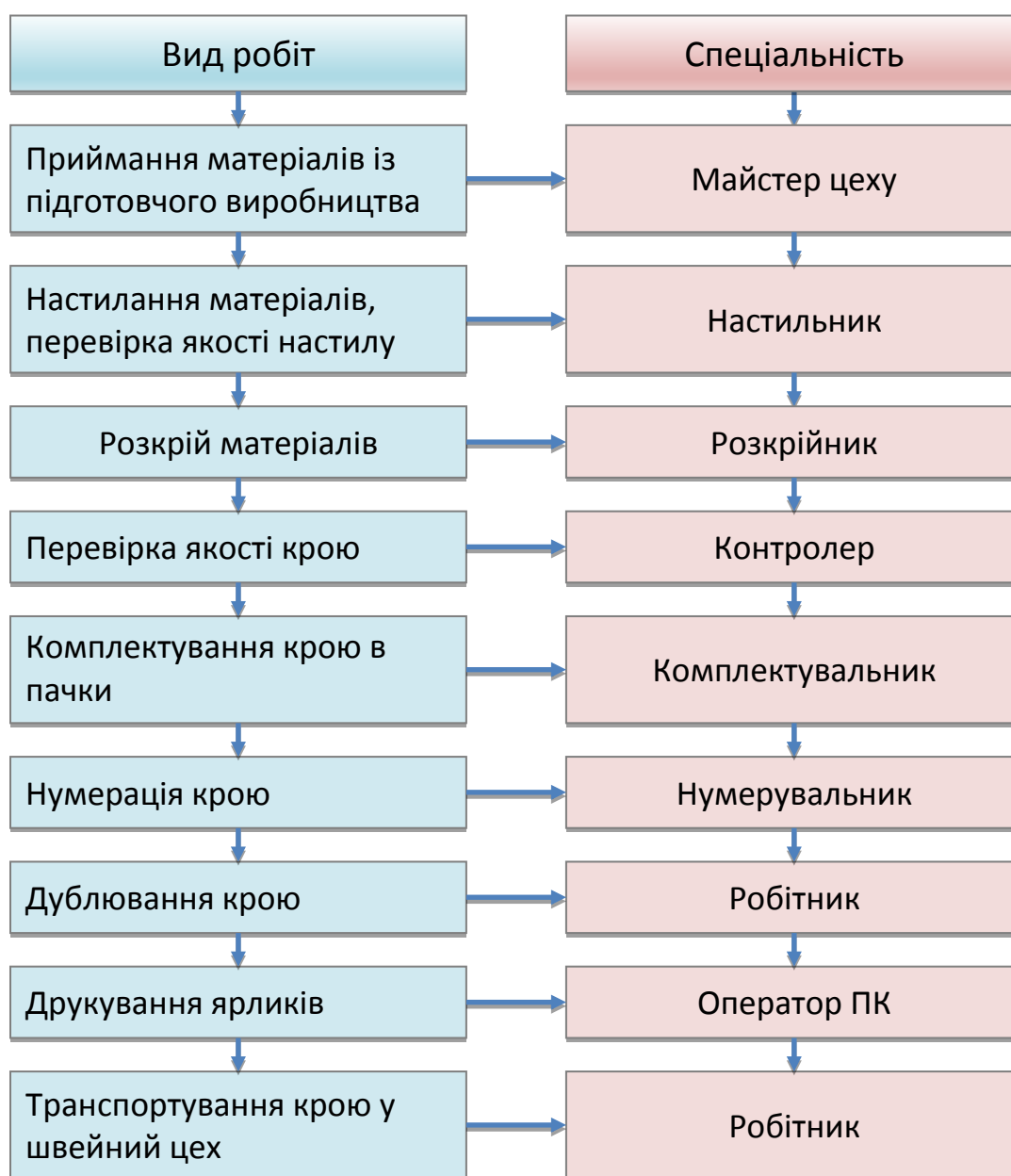
Рис. 4.1. Структурна схема технологічного процесу розкрою матеріалів
