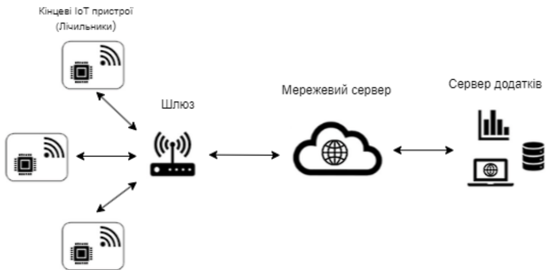
Рис. 2.2. Структурна схема автоматизованої системи моніторингу виробництва та розподілу електроенергії (на базі бездротової сенсорної мережі LoRaWAN)
