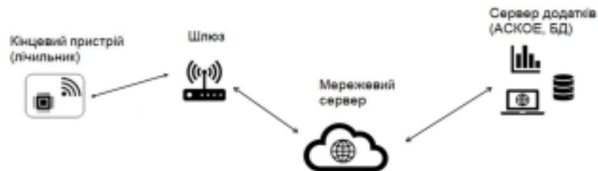
Рисунок 1 – Застосування архітектури мережі LoRaWAN для моніторингу виробництва електроенергії суб'єктами альтернативної енергетики
