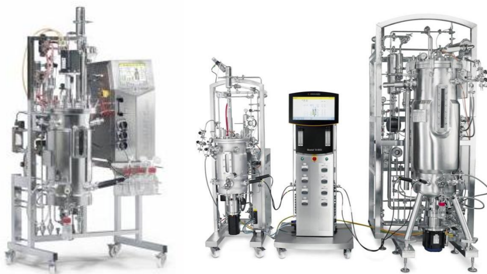
Рис.2.2. Приклади біореакторів компанії Sartorius Sartorius BIostat® Cplus3 і Sartorius BIostat® DCU3
