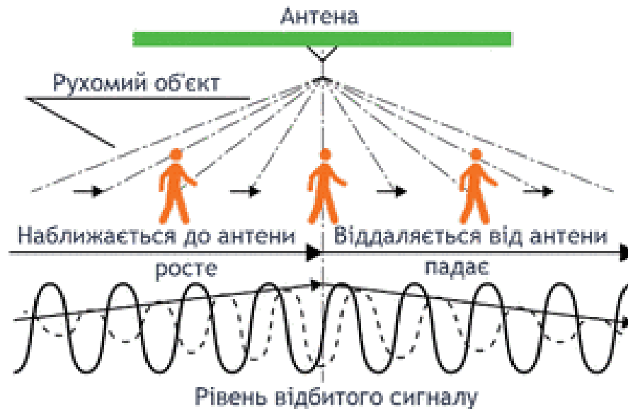
Рис. 1.10(ілюстрація роботи МХ датчика)
