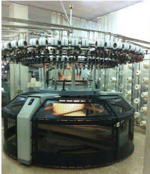
Рис.8.4.17. Форма лінії заправки ниток круглов'язальної машини Мауер
