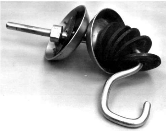
Рис.5.4.18. Загальний вигляд нитконатягувального приладу
