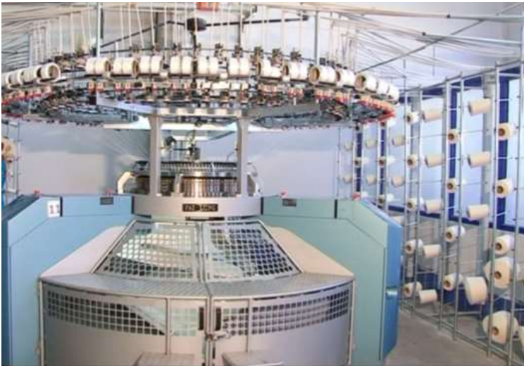
Рис.8.4.21. Форма лінії заправки ниток круглов’язальної машини PaiLung
