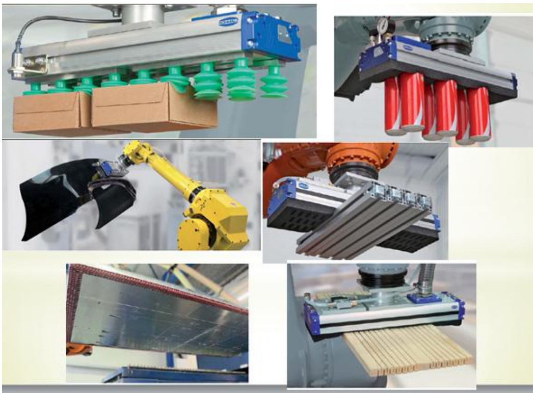
Рисунок 7 Варіанти застосування вакуумних захватів при автоматизації процесів різних промисловостей
