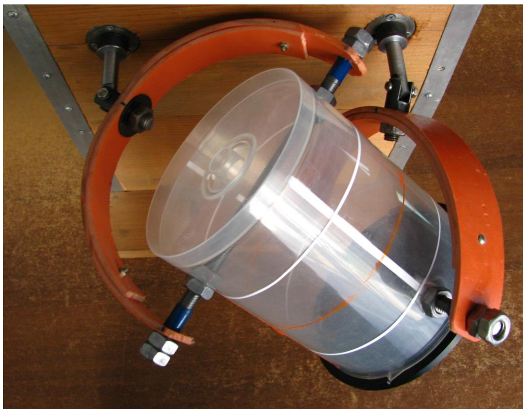
Рис. 1.8. Фото розробленого експериментального стенду машини зі складним просторовим рухом робочої ємності
