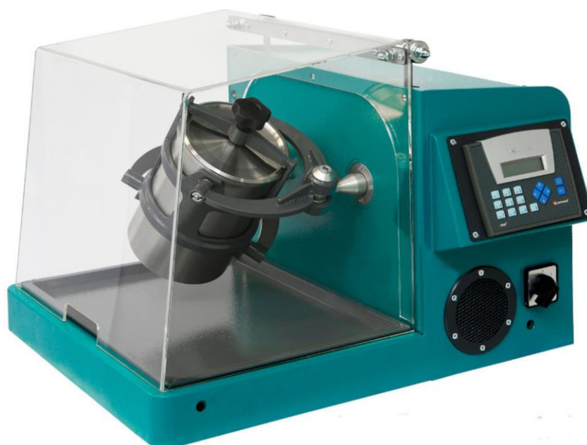
Рис. 1.2. Промисловий змішувач «Turbula»
