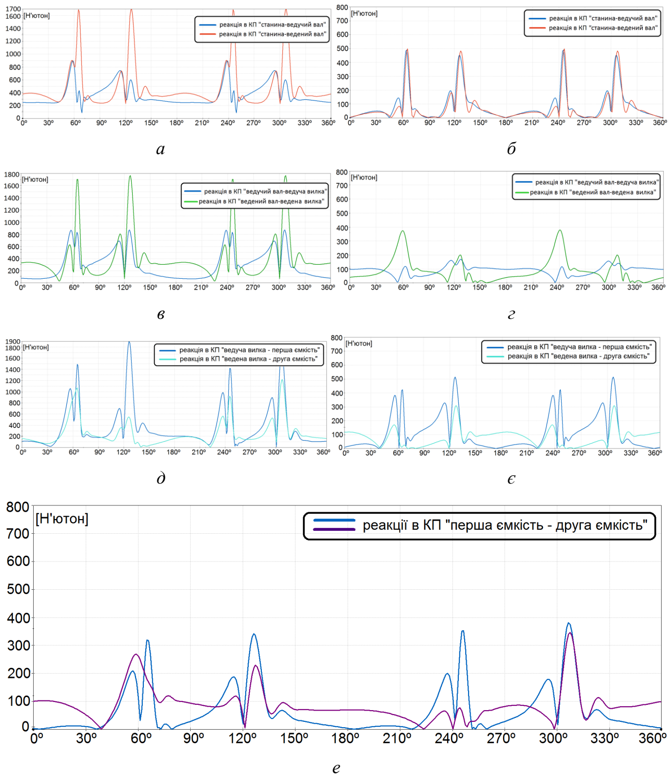
Рис. 3.56. Залежності реакцій від кута повороту ведучого валу машини з двома робочими ємностями, що з'єднані між собою поступальною кінематичною парою, при коефіцієнті \lambda=1,6 ( a , в , д – радіальні складові реакцій; б , г , е – осьові складові реакцій; e – реакція в поступальній КП)
