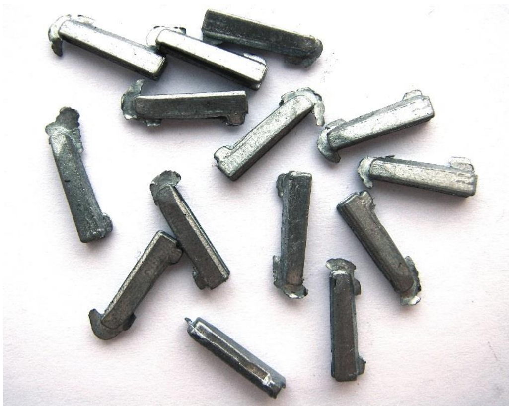
Рис. 4.15. Відокремлені від ливників деталі-фіксатори із залишками облою та заусенціями
