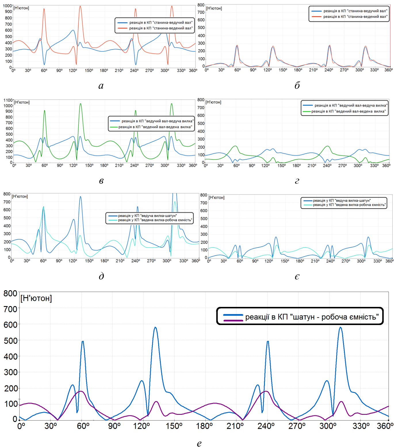
Рис. 3.62. Залежності реакцій від кута повороту ведучого валу машини з додатковою рухомою ланкою шатуном, що містить обертальну та поступальну кінематичні пари, при коефіцієнті \lambda=1,4 ( a , в , д – радіальні складові реакцій; б , г , є – осьові складові реакцій; е – реакція в КП «шатун-робоча ємність»)
