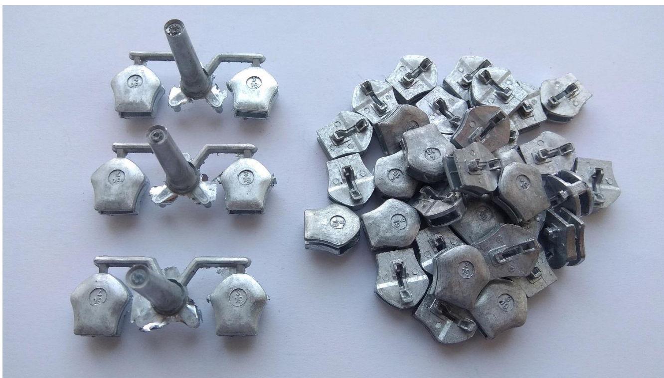
Рис. 4.10. Відливки замка «блискавка» до початку обробки, а також відокремлені деталі по завершенню обробки в експериментальній установці
