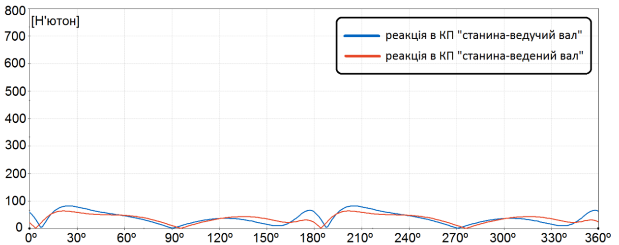
Рис. 3.4. Залежності величини осьових реакцій R_{AA} та R_{FA} від кута повороту ведучого валу при роботі машини без завантаженого масиву
