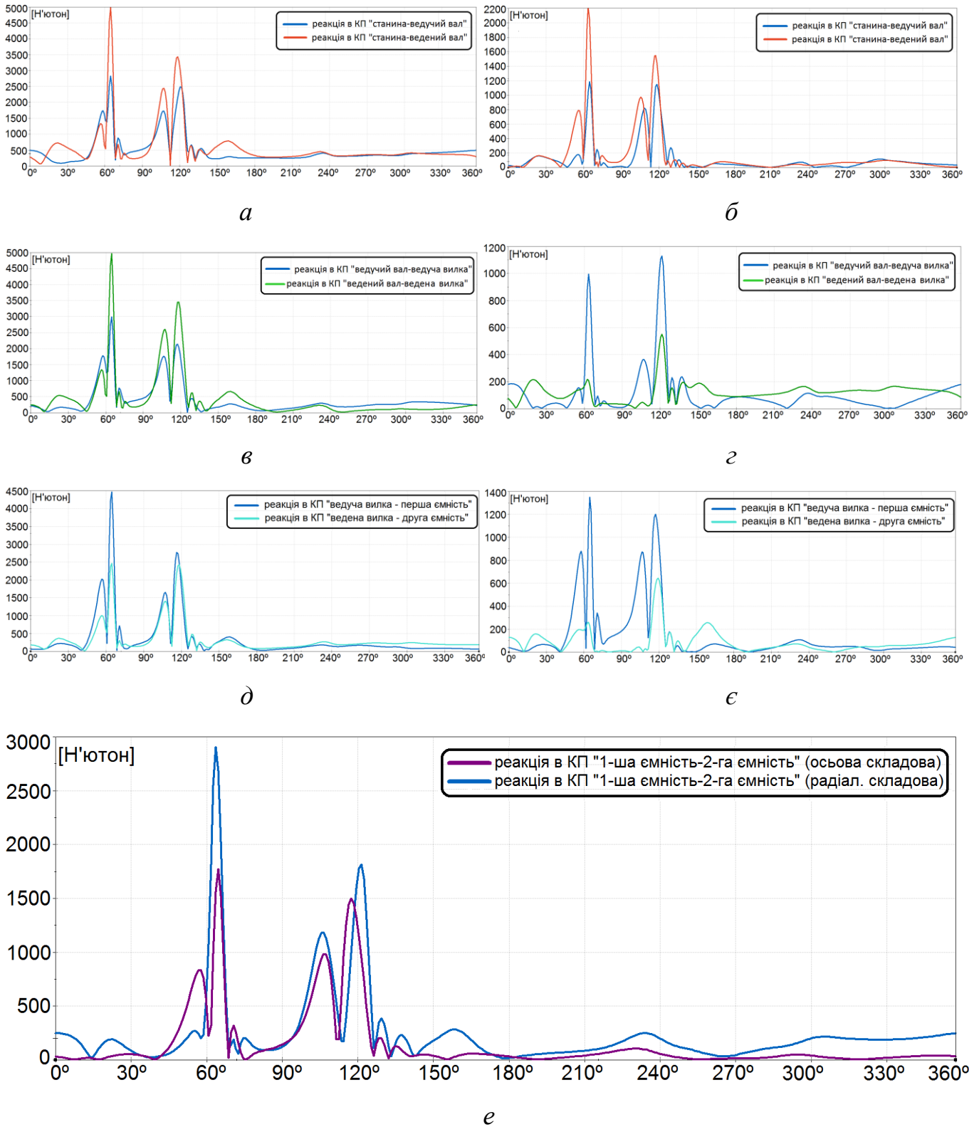
Рис. 3.78. Залежності реакцій від кута повороту ведучого валу машини з двома робочими ємностями, що з'єднані між собою оберальною кінематичною парою, при коефіцієнті \lambda=1,8 (а, в, д – радіальні складові реакцій; б, г, е – осьові складові реакцій; е – реакція в оберальній КП)
