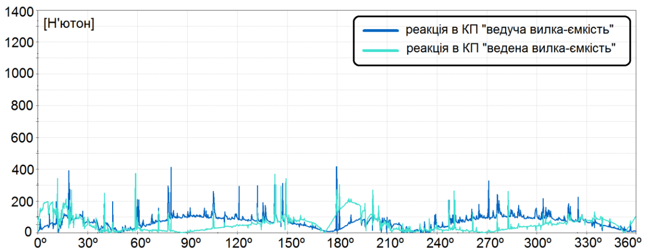
Рис. 3.14. Залежності величини осьових реакцій R_{CA} та R_{DA} від кута повороту ведучого валу при роботі машини із завантаженим масивом масою 14 кг
