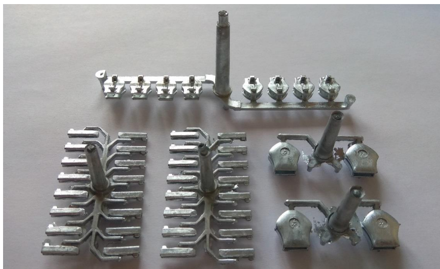
Рис. 4.3. Відливки замка «блискавка», що використовувалися у експерименті
