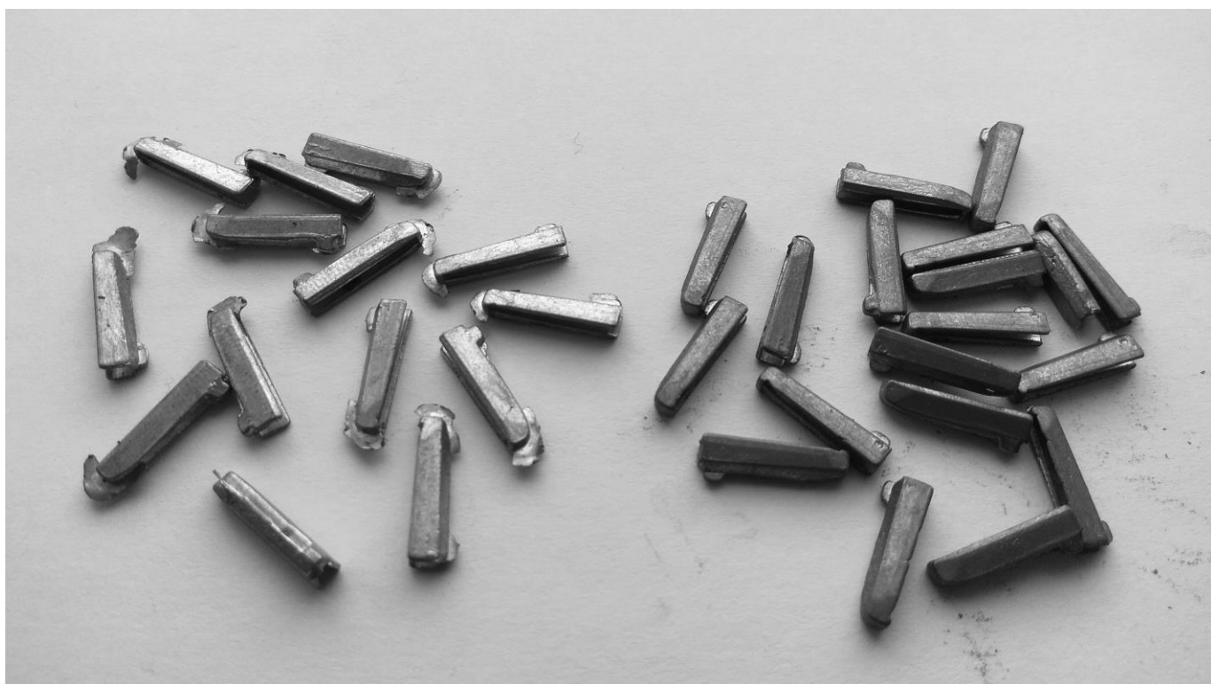
Рис. 4.16. Порівняльне фото відокремлених від ливників деталей-фіксаторів із залишками облою, заусенціями, а також з видаленим облоєм та заусенціями
