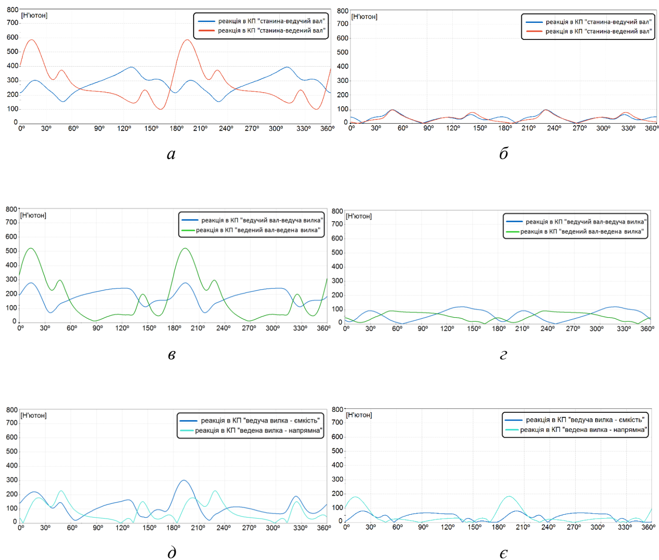
Рис. 3.45. Залежності реакцій від кута повороту ведучого валу машини, в якій ведена вилка з'єднана з робочою ємністю за допомогою кінематичної пари 4-го класу, при коефіцієнті \lambda=1,2 ( a, в, д – радіальні складові реакцій; б, г, е – осьові складові реакцій)
