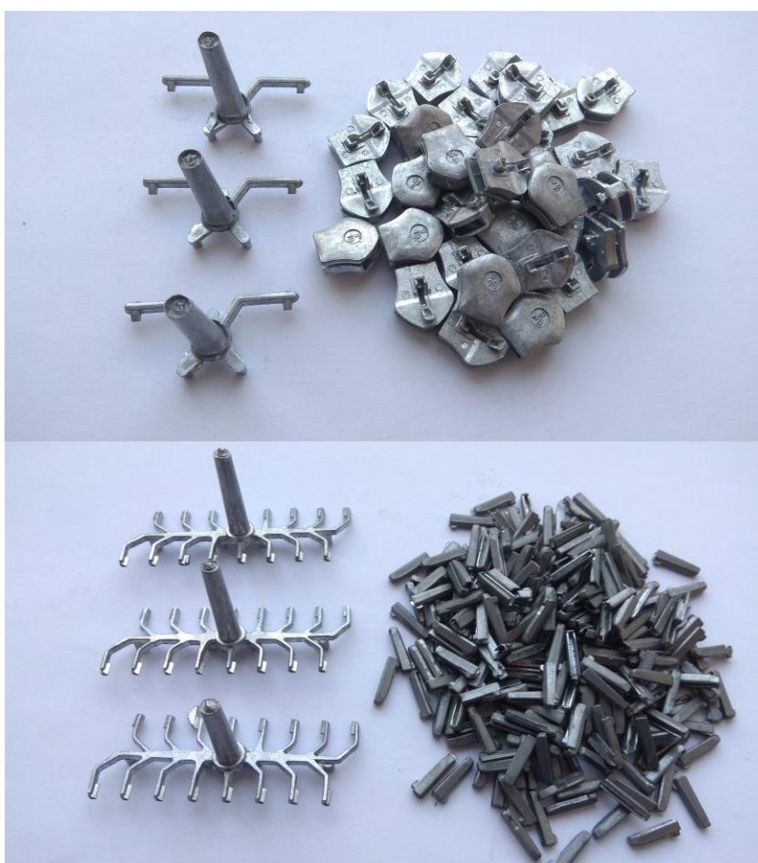
Рис. 5.5. Фото оброблених металевих деталей замка «блискавка» та відокремлених ливників
