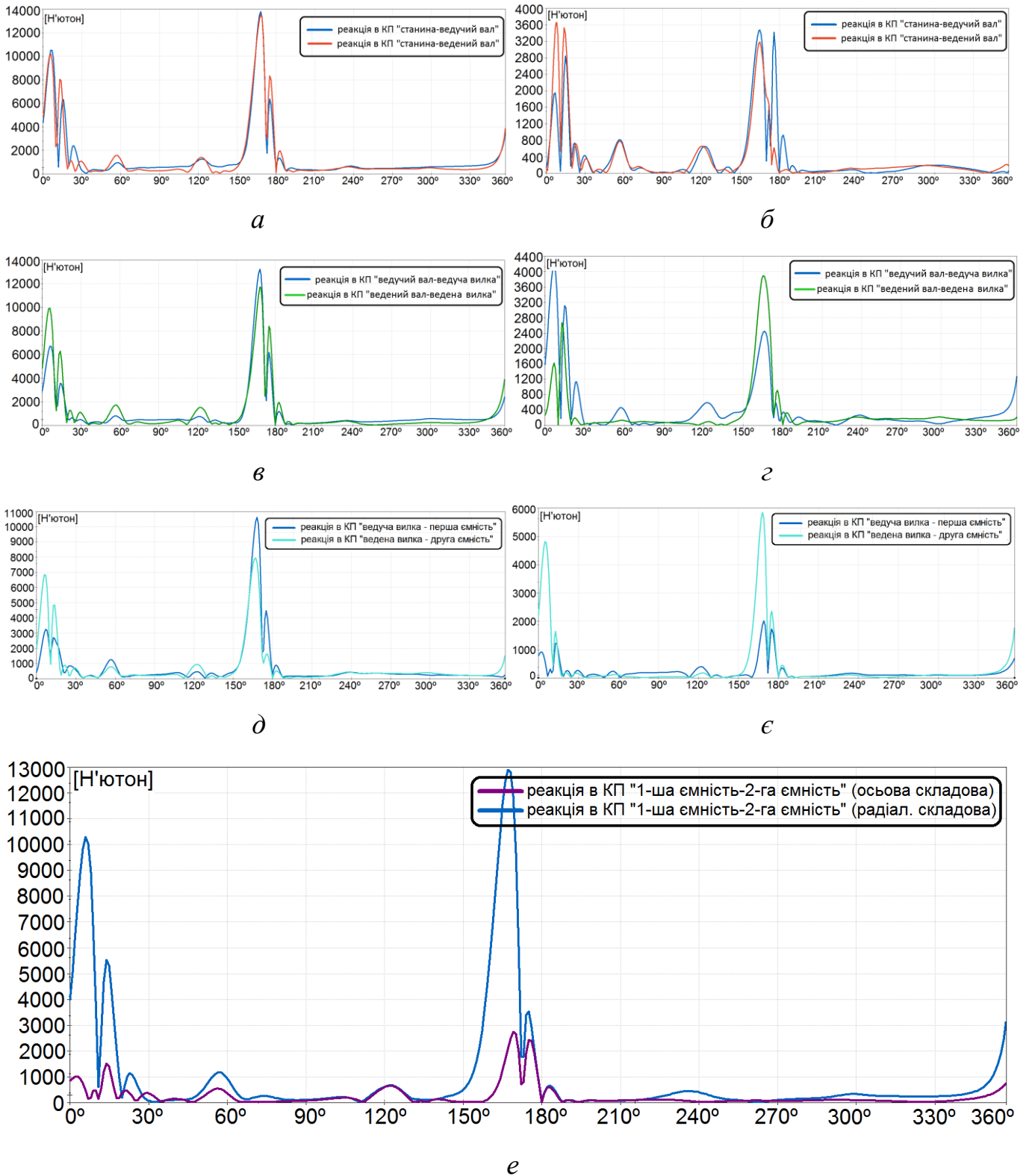
Рис. 3.75. Залежності реакцій від кута повороту ведучого валу машини з двома робочими ємностями, що з'єднані між собою обертальною кінематичною парою, при коефіцієнті \lambda=1,2 (а, в, д – радіальні складові реакцій; б, г, е – осьові складові реакцій; е – реакція в обертальній КП)
