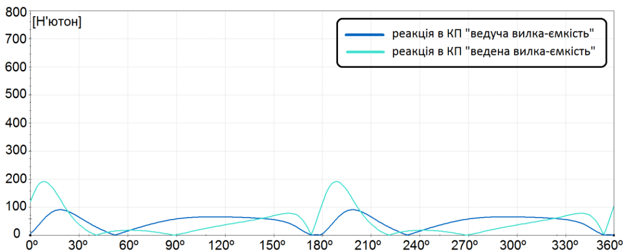
Рис. 3.8. Залежності величини осьових реакцій R_{CA} та R_{DA} від кута повороту ведучого валу при роботі машини без завантаженого масиву
