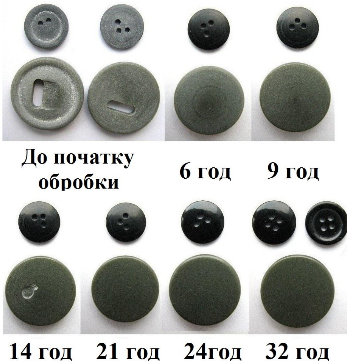
Рис. 1.6. Фото зразків полімерних деталей, які пройшли відповідний час обробки у ємності, яка виконує складний просторовий рух
