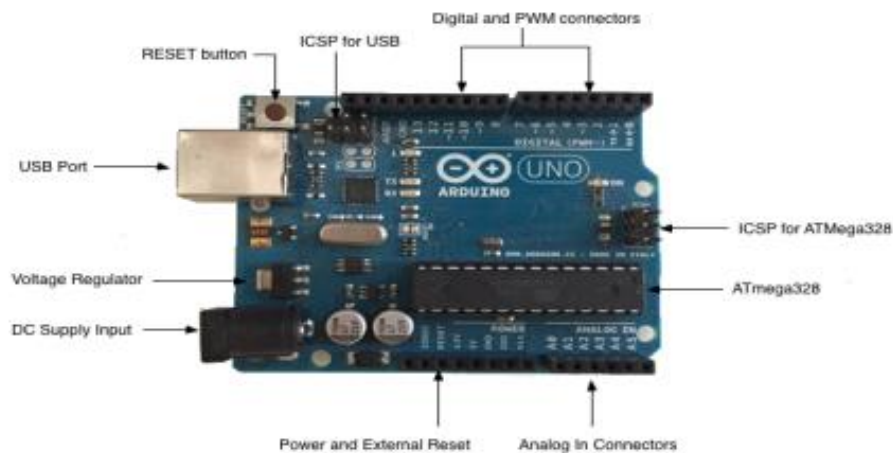
Рис 2.2 – Спрощена принципова схема плати Arduino Uno R3
