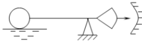
Рис 2.15 – Схема поплавкового рівнеміра вузького діапазону
