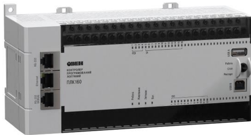
Рис 4.10 – Програмований логічний контролер ПЛК160
