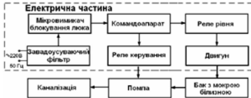
Рис. 1.8. Структурна схема системи віджимання в автоматичній пральній машині
