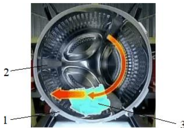
Рис. 1.1. Схема процесу центрифугування
