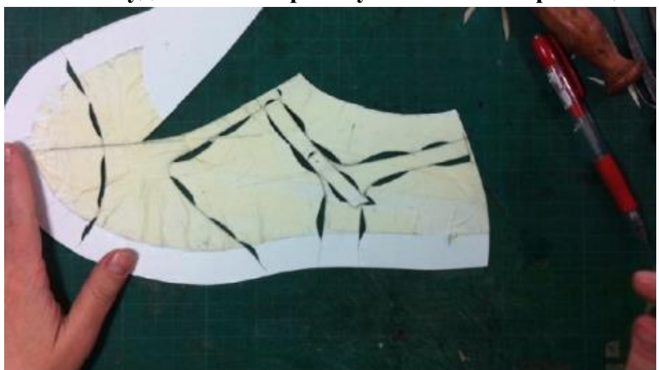
Рис. 3.11 – Отримання ґрунд-моделі взуття
