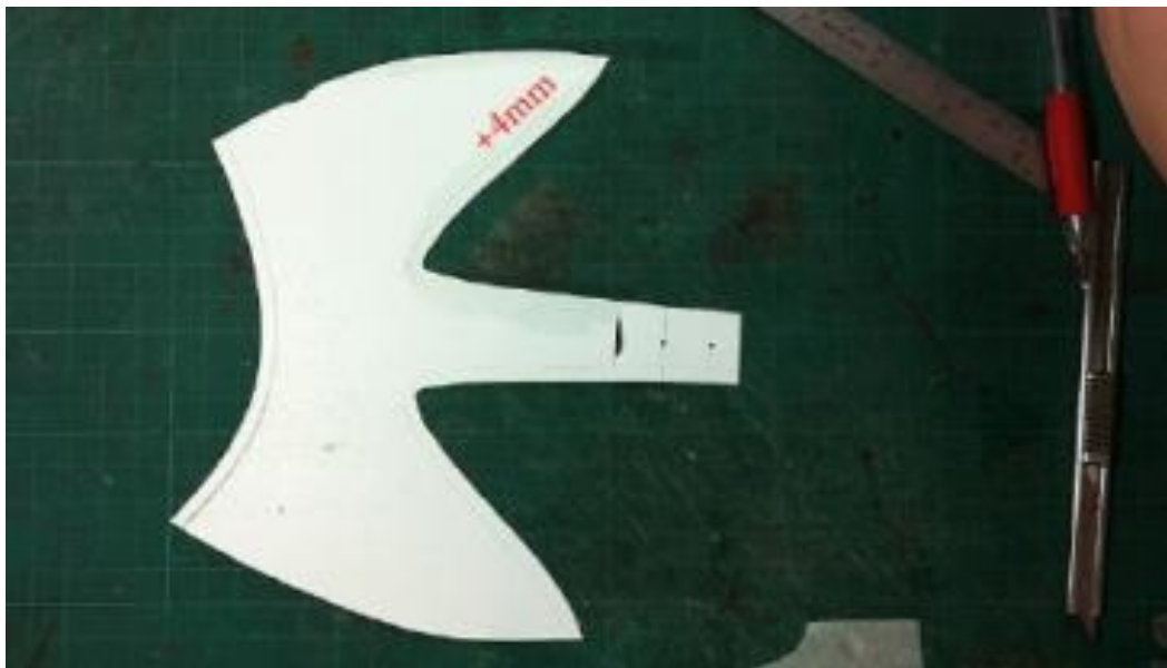
Рис. 3.16 – Коригована деталь союзки з припусками
