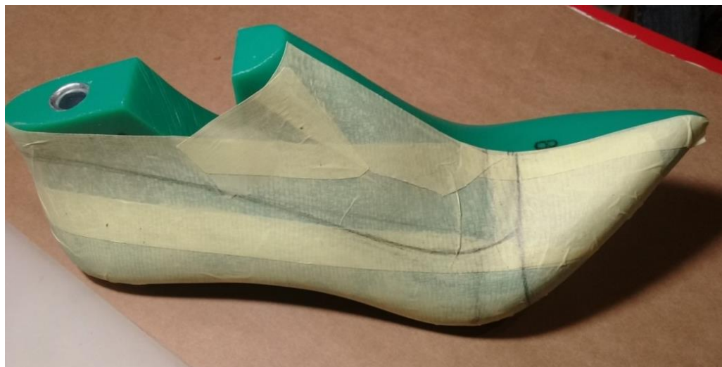
Рис. 2.20 – Нанесення контуру лінії канта туфель
