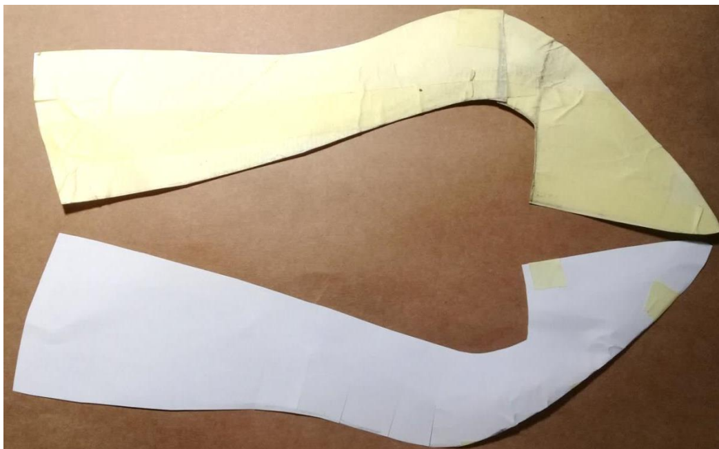
Рис. 2.27 – Отримання відкорегованого зовнішнього та внутрішнього шаблону союзки
