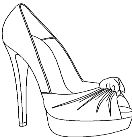
Рис. 2.34 – Ескіз моделі туфель з гофрованою союзкою та відрізним носком
