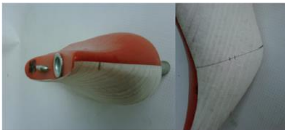
Рис. 1.5 – Проведення лінії пучків колодки та висоту туфель
