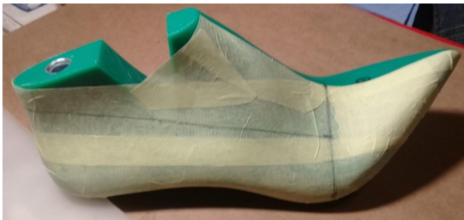
Рис. 2.19 – Нанесення контрольних ліній на колодку
