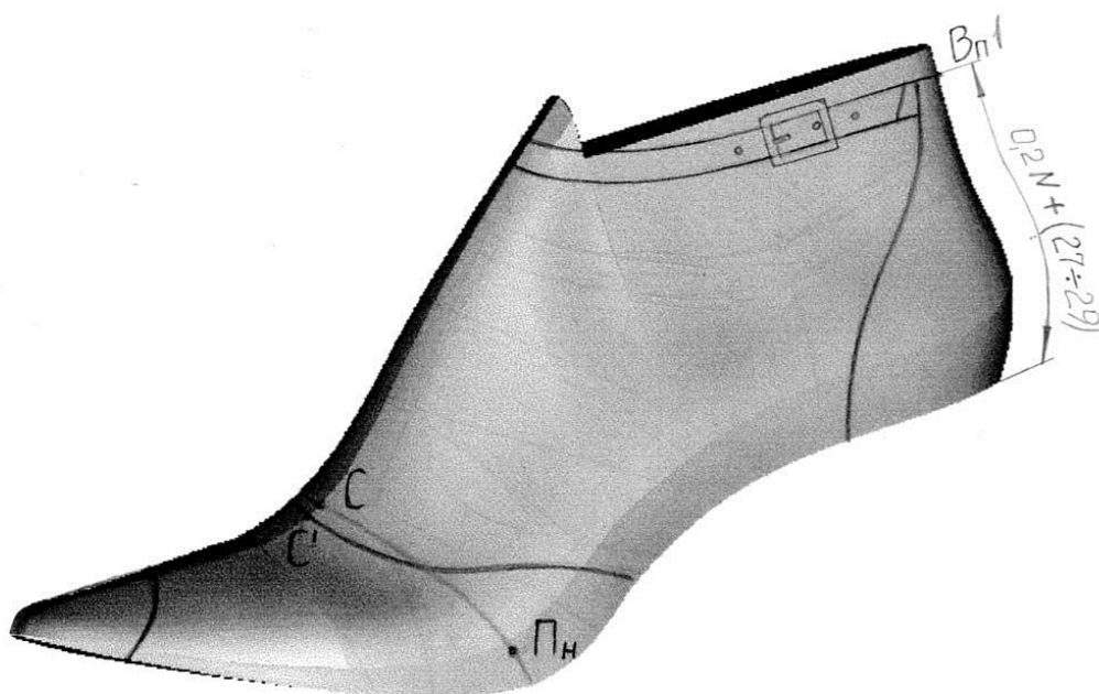
Рис. 3.48 – Нанесення конструктивних ліній на поверхню колодки
