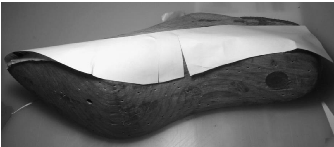
Рис. 2.15 – Накладання шаблону внутрішньої частини туфель на поверхню колодки
