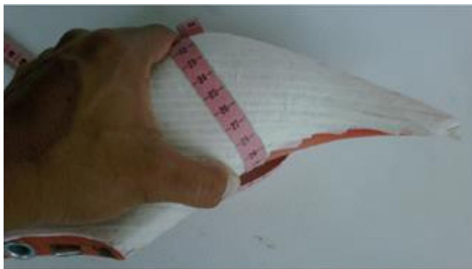
Рис. 1.4 – Визначення зовнішнього і внутрішнього пучка колодки
