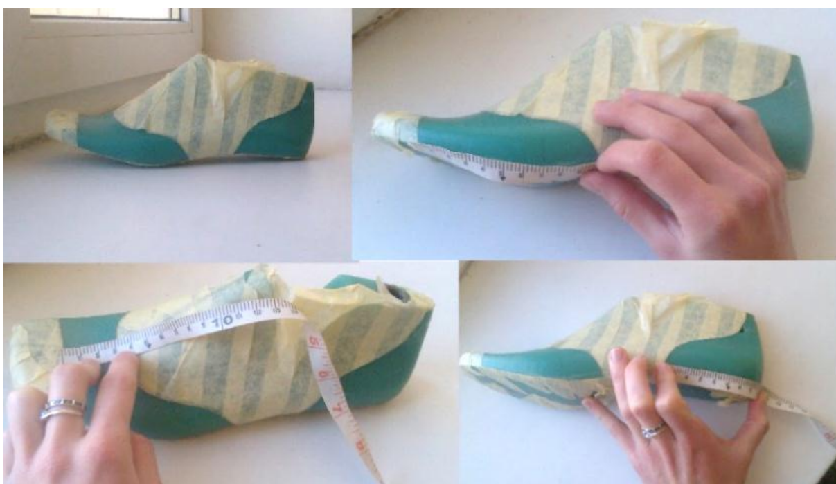
Рис. 3.49 – Етапи отримання фрагментної оболонки з колодки
