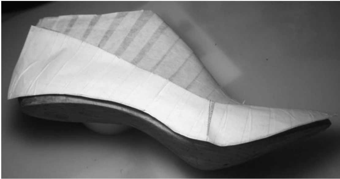
Рис. 2.11 – Результат накладання зліпку на колодку після коригування
