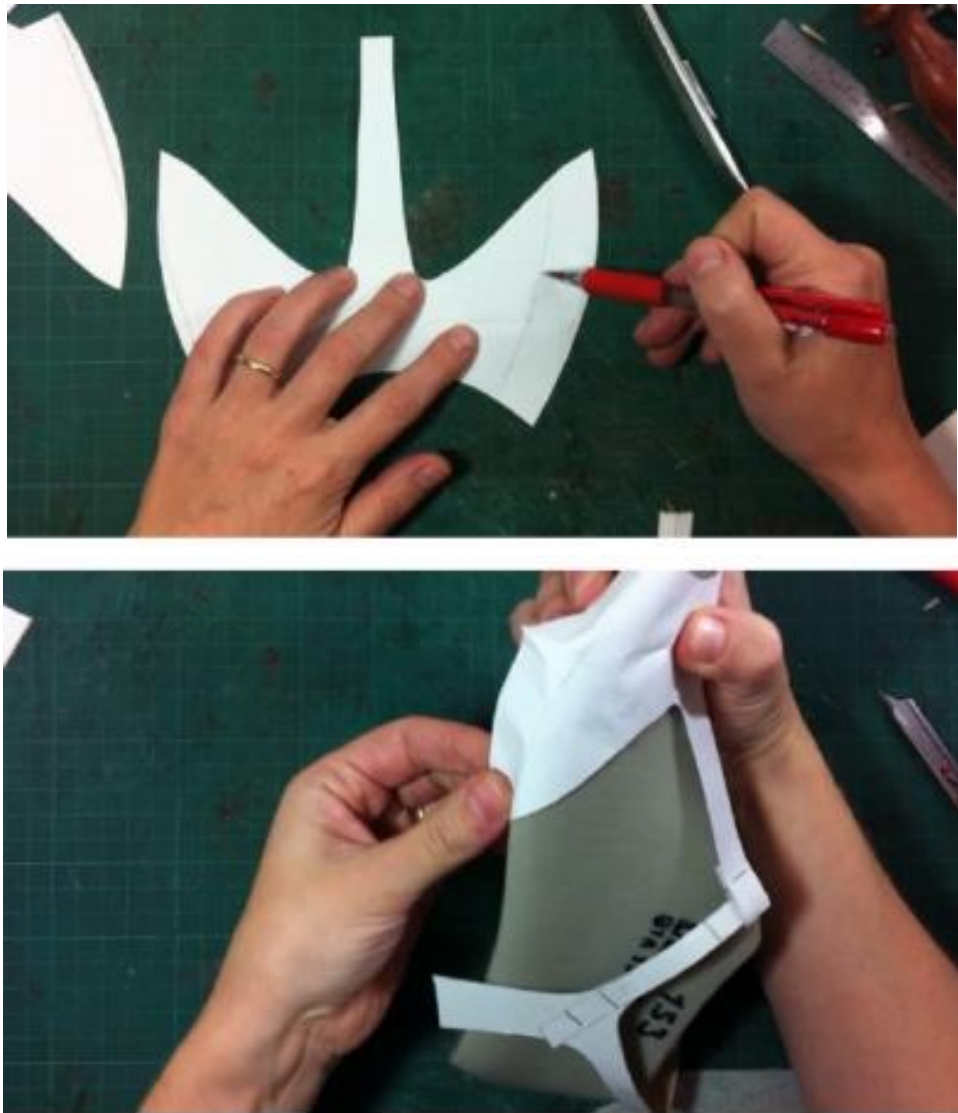
Рис. 3.14 – Перевірка макету заготовки верху по колодці
