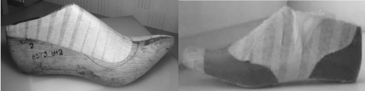
Рис. 1.20 – Отримання ґрунд-моделі з колодки за адаптованою методикою
