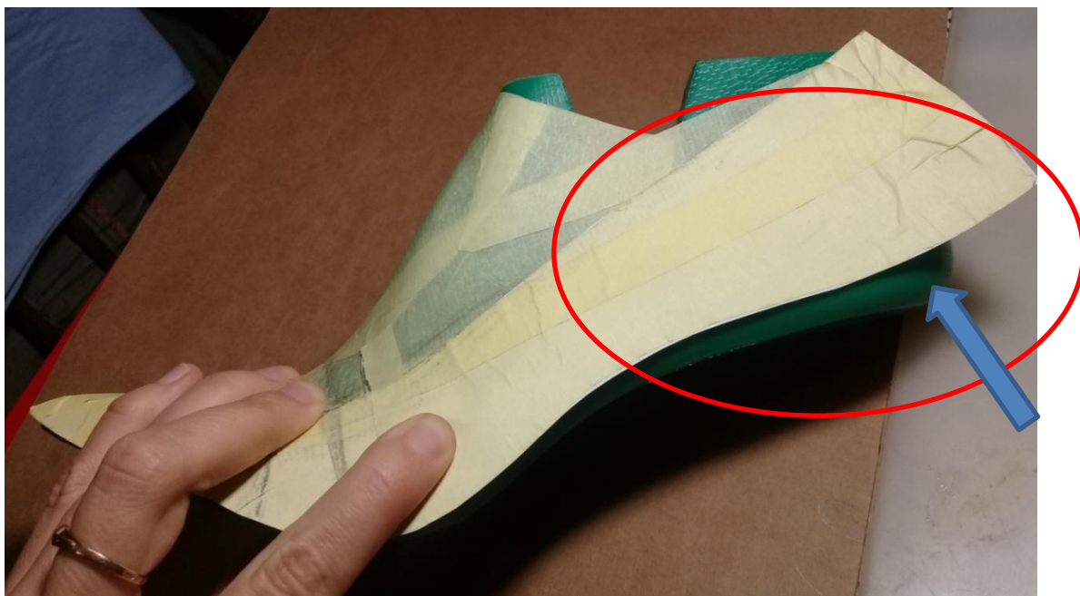
Рис. 2.24 – Контрольна перевірка посадки крила союзки
