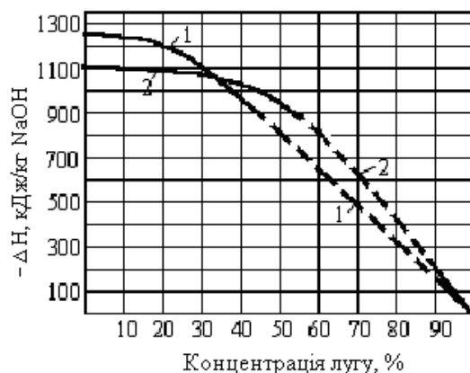
Рис. 7.10 Діаграма для визначення теплоти розчинення лугів у воді: 1 – теплота розчинення NaOH (тв.); 2 – теплота розчинення KOH (тв.)
