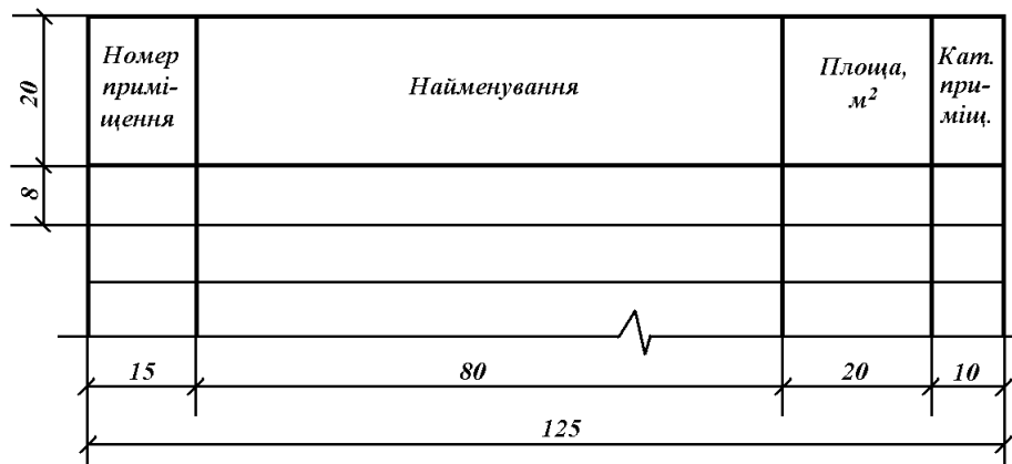
Рис. 7.15 Форма експлікації приміщень на будівельних кресленнях: в останньому стовпці приводиться категорія приміщень по вибухопожежній і пожежній небезпеці
