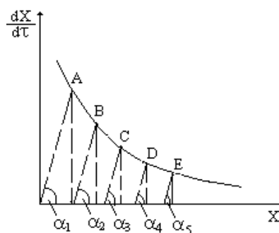
Рис. 7.5 Залежність швидкості реакції від концентрації кінцевого продукту.
