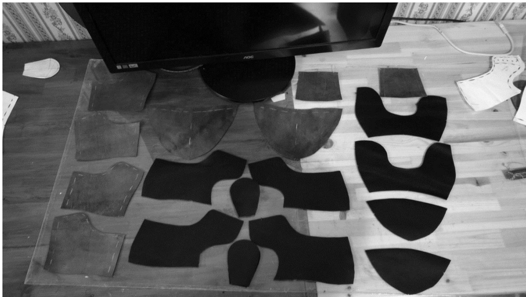
Рис.5 Розкрій матеріалів на деталі верху та підкладки заготовки взуття
