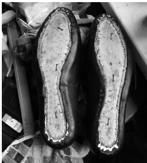
Рис.10. Обрізка складок по сліду взуття
