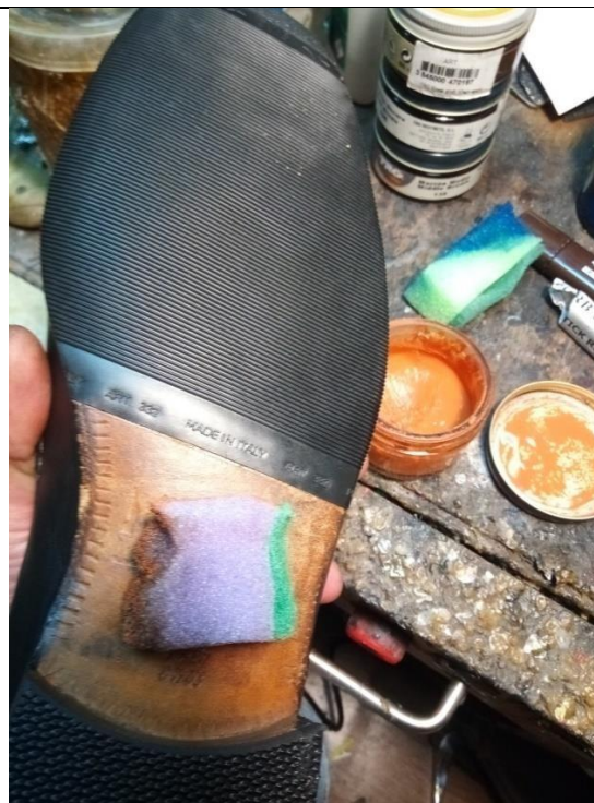
Нанесення водовідштовхуючого крему на шкіру низа взуття.
