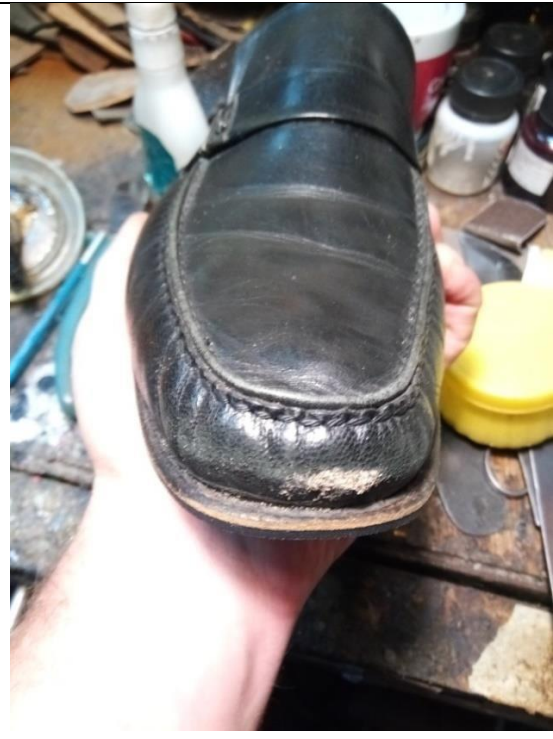
Нанесення шпаклівки на ушкоджені ділянки шкіри верху. Сушка.
