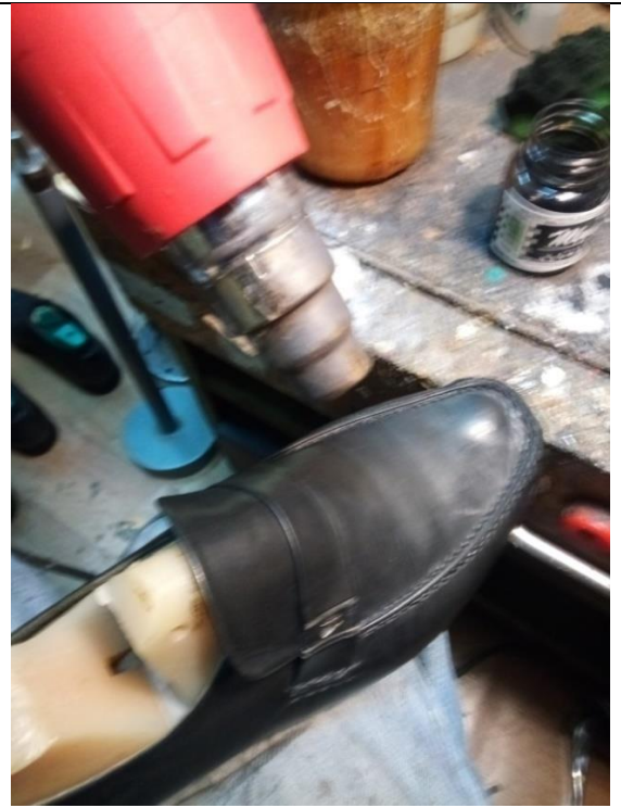
Нагрів ділянок для подальшої усадки до форми колодки.
