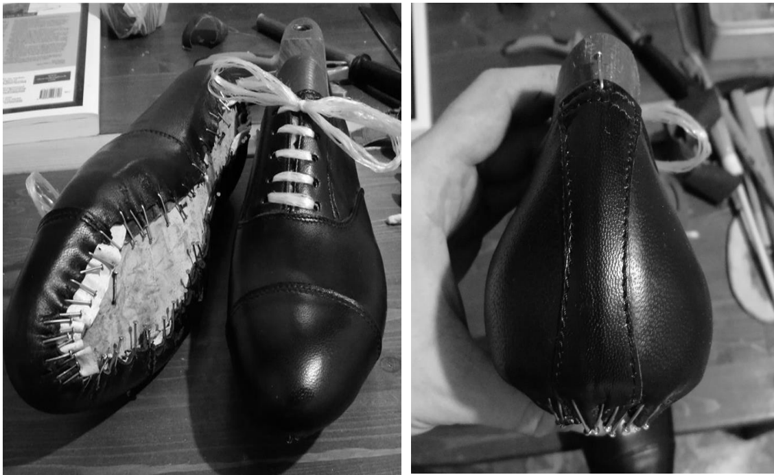
Рис.9. Затяжка пакету верху взуття
