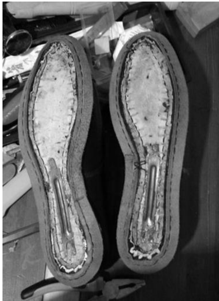
Рис.12. Встановлення металевго геленка
