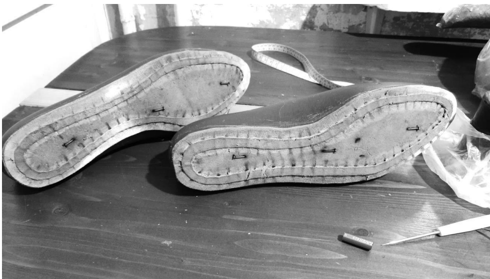
Рис.8. Підготовка устілки для пришивання ранта
