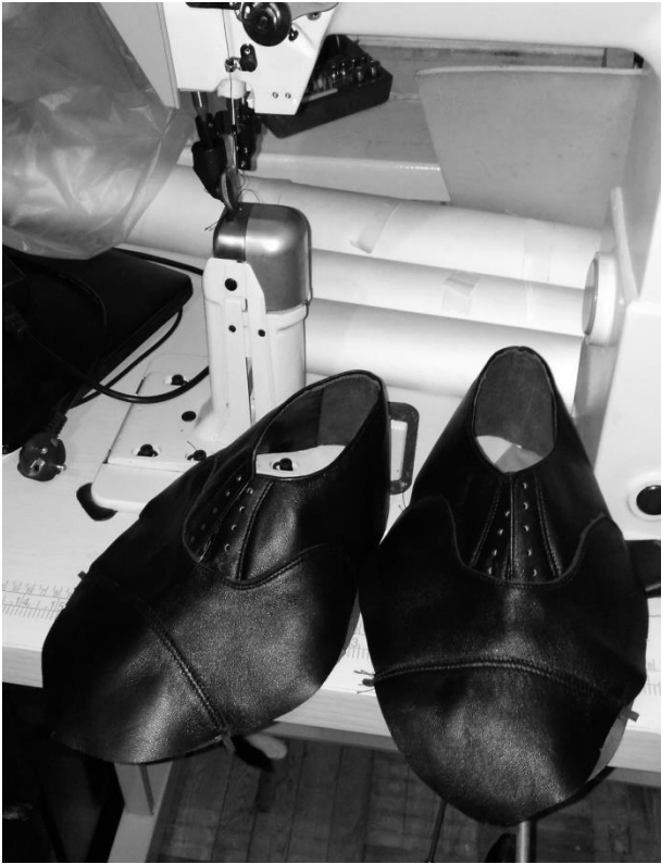
Рис.6. Складання деталей верху і підкладки Рис.7. Попередня затяжка заготовки на колодку
