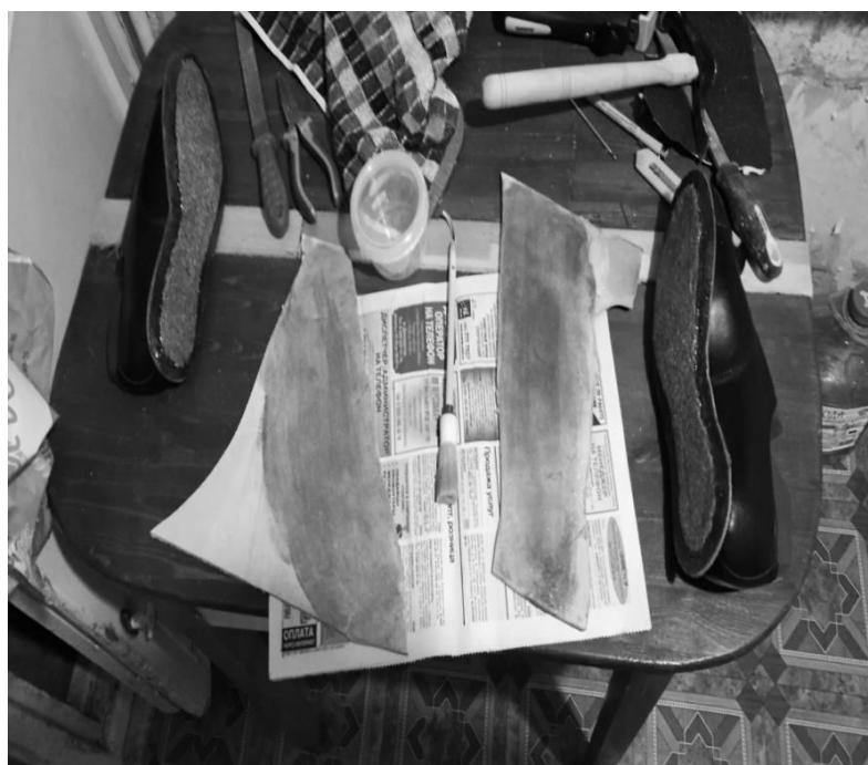
Рис.14. Намазка клеєм підошви і сліду взуття
