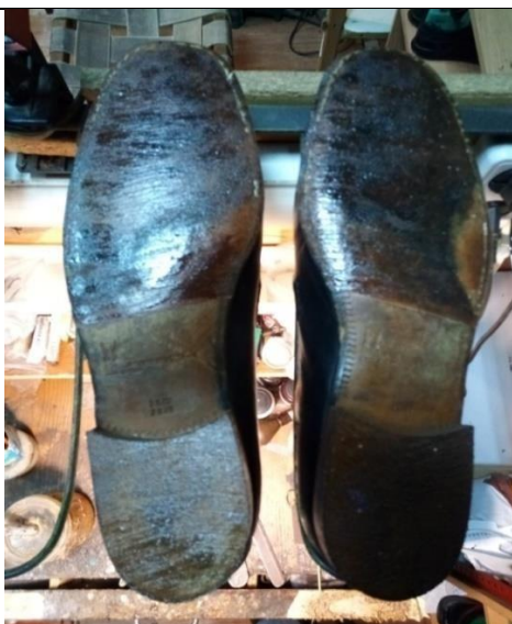
Дворазова намазка клеєм підошви та каблука.
