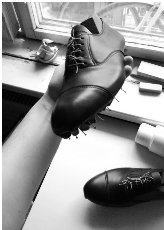
Рис.6. Складання деталей верху і підкладки Рис.7. Попередня затяжка заготовки на колодку
