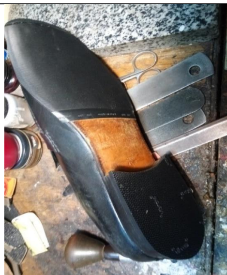
Термоактивація клейової плівки, склеювання. Чернова підрізка наклеєних деталей.
