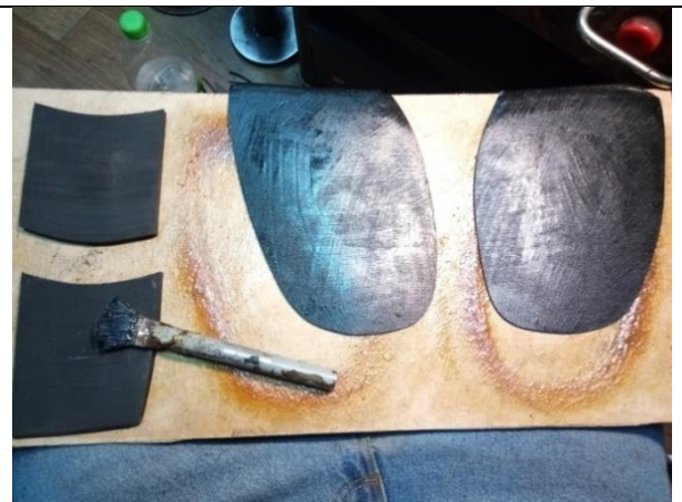
Намазка клеєм заготовок набійки та підметки.
