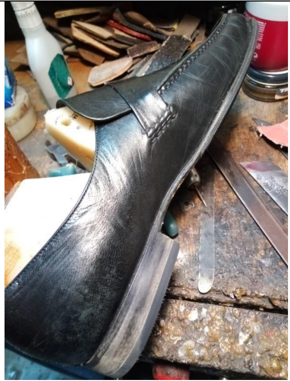
Обробка урізу підшви та каблука.
