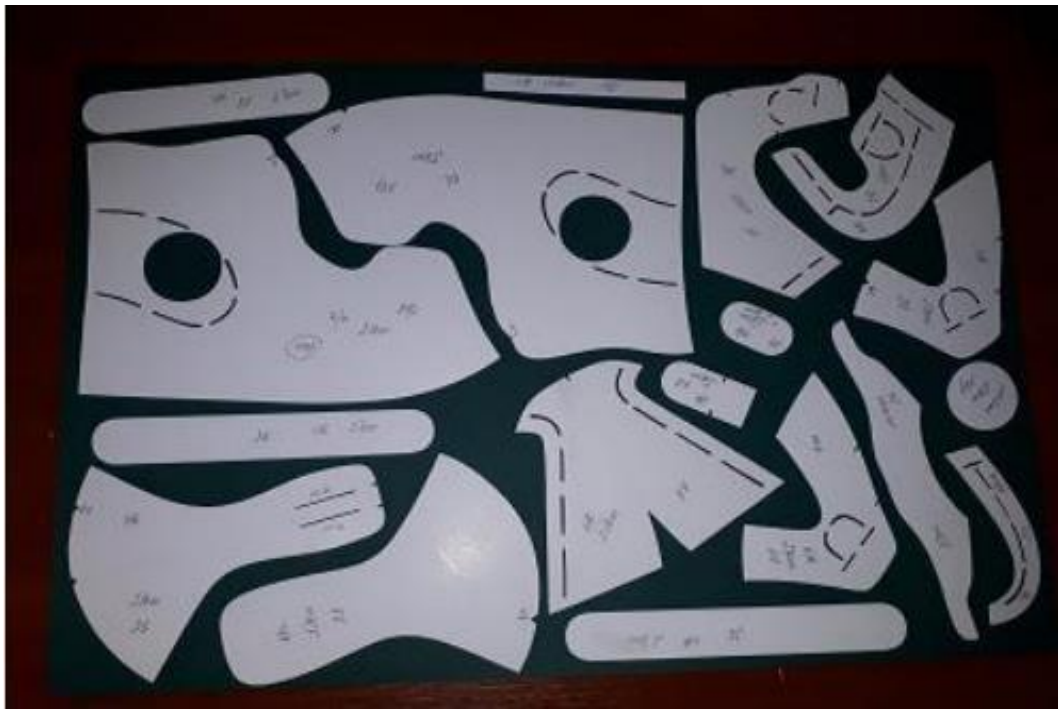
Рис. 3. Лекала моделі дитячого взуття
