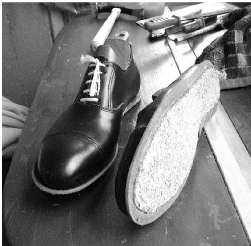
Рис.13. Простилання сліду взуття
