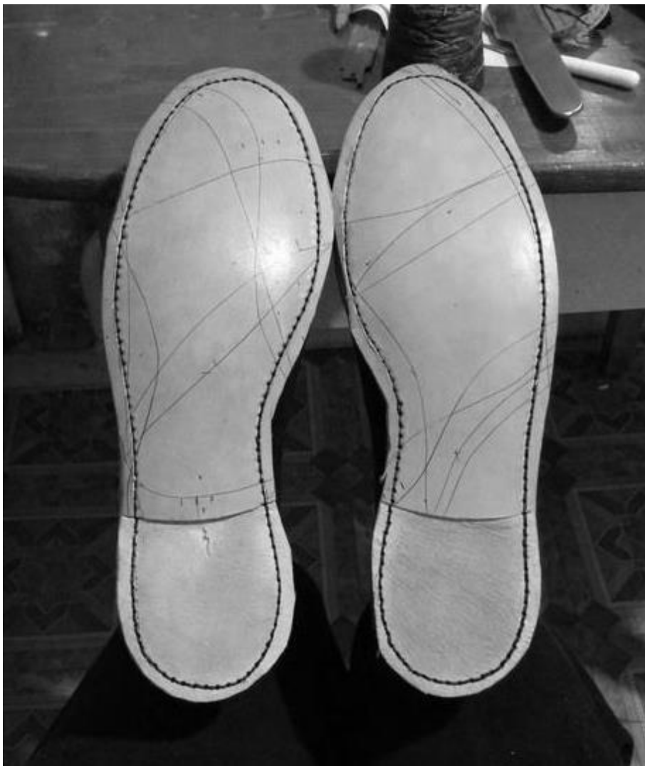
Рис.16. Підготовка місця під каблук , прошивка ранта з підошвою в кругову
