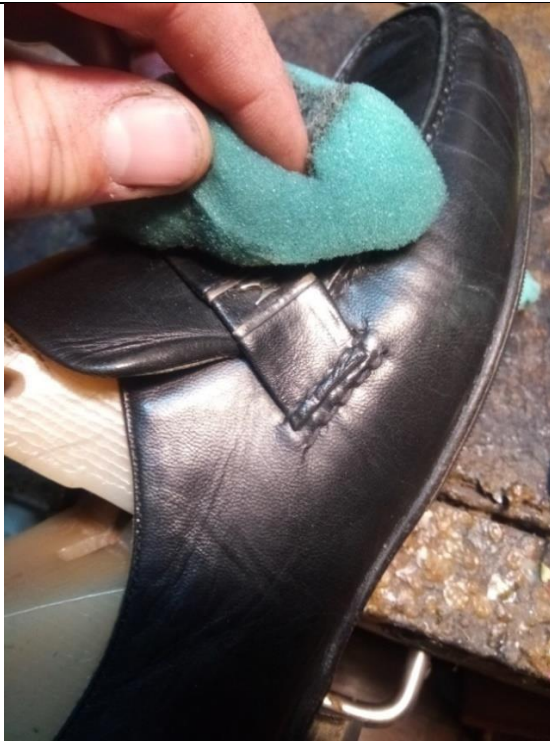
Підмочування деформованих ділянок взуття.
