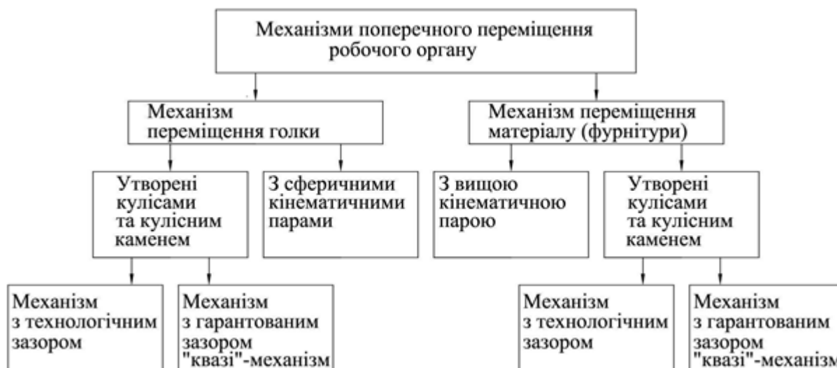
Рис. 6. Класифікація механізмів поперечного переміщення робочих органів
