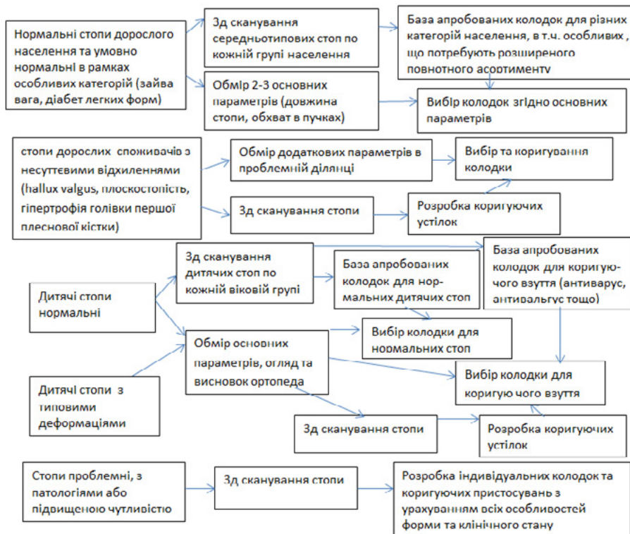
Рисунок 3 – Алгоритм отримання та використання необхідної антропометричної інформації для розробки параметрів взуттєвої колодки для різних категорій населення
