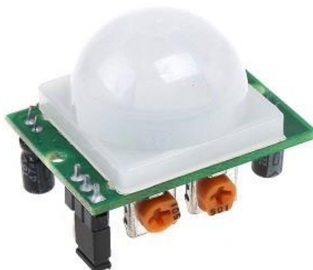
Рис. 2.9 Інфрачервоний датчик руху HC-SR501
