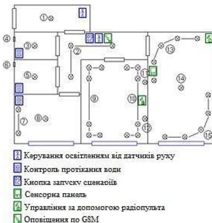
Рис. 1.5 – Схема з використанням датчиків протікання води
