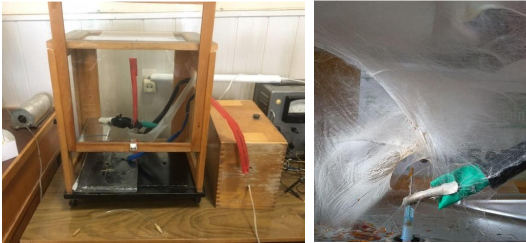
Рис.2.2 Лабораторна установка для виготовлення нетканних матеріалів методом електроформування
