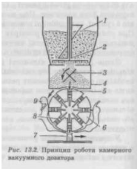
Рисунок 3.2 – Принцип роботи камерного вакуумного дозатора
