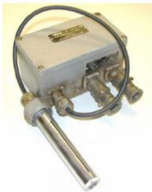
Рис. 3.4 - Загальний вигляд датчика рівня магнетиту РУМ-3
