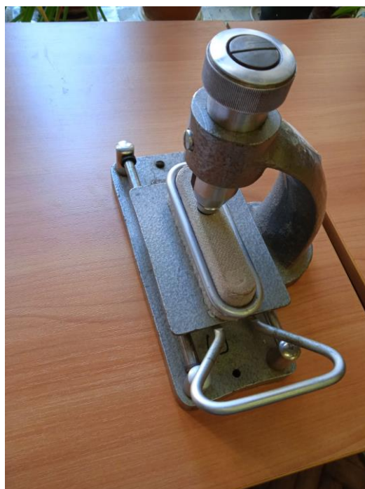
Рисунок 3.1 – Схема та зовнішній вигляд приладу ПТ-4 ЦНІВ шовку для визначення стійкості фарбування до тертя
