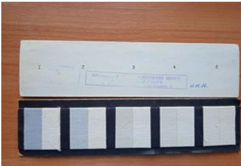
Рисунок 3.4 – Шкала сірих еталонів для оцінювання міцності фарбування на зафарбовування білої суміжної проби (міткалі)
