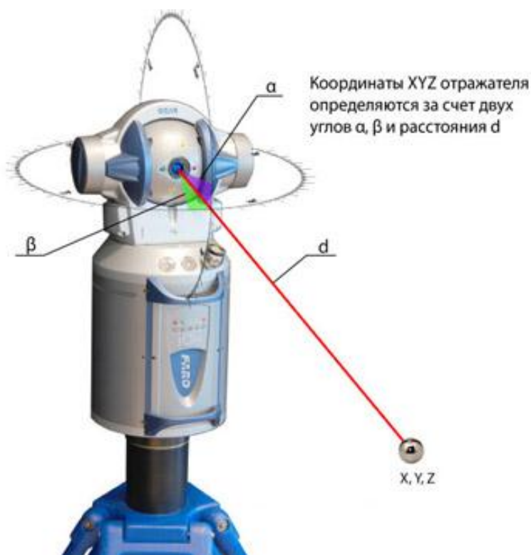
Рис. 12. Координатно-вимірювальна машина - лазерний трекер Laser Vantage
