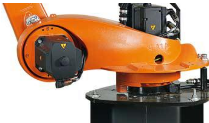
Рис. 7. Розташування 2 осі додатково забезпечує високу гнучкість та надзвичайну доступність до об'єкту
