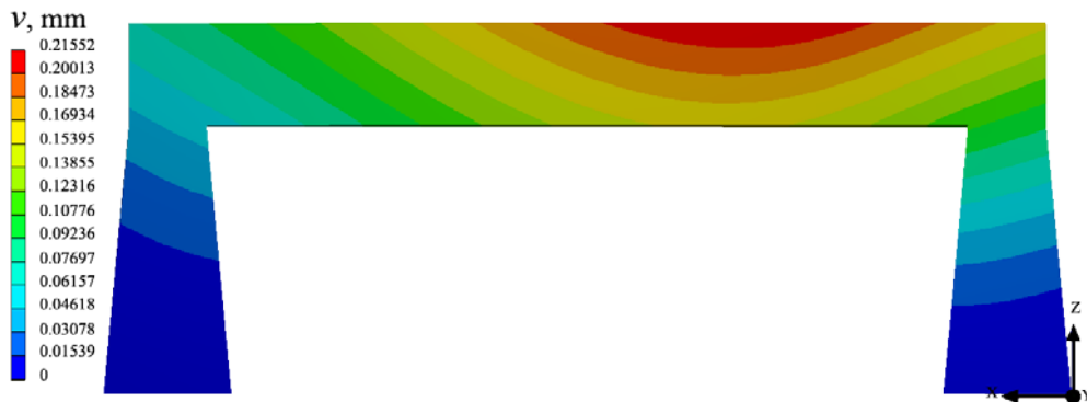
Рис. 3.5. Розподіл прогинів пружної пластини з консолями трапецієвидної форми при a_i(0)=2,3 \text{ мм} та H=10,9 \text{ мм}
