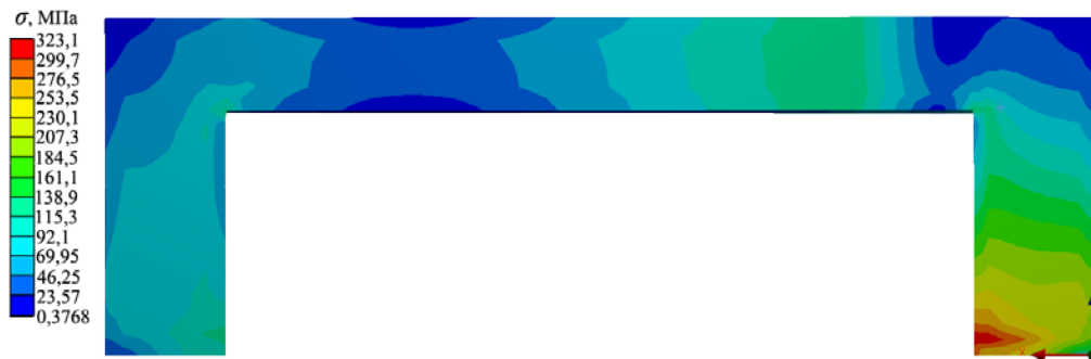
Рис. 3.4. Розподіл еквівалентних напружень на поверхні пружної пластини прямокутної форми При B=3,8 мм, H=10,9 мм
