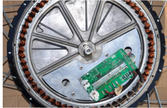
Рисунок 3 – Загальний вигляд двигуна мотор-колеса
