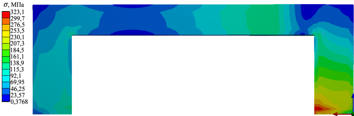
Рис. 3. Розподіл еквівалентних напружень в податливій грані клину
